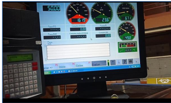
Figura 42: Medición de Lambda. Fuente: (Autor, 2021)
