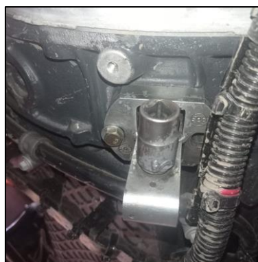
Figura 48: Acople de los piñones. Fuente: (Autor, 2021)
