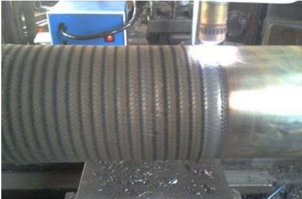
FIGURA 3. Recubrimiento duro por soldadura tubular. (HEBEI METALS INDUSTRIAL LIMITED, 2016)
