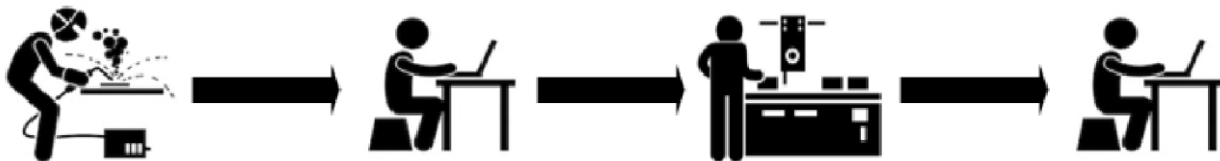
FIGURA 20. Proceso para determinación de parámetros de diseño mecánico y control para el proceso de revestimiento con soldadura dura.
