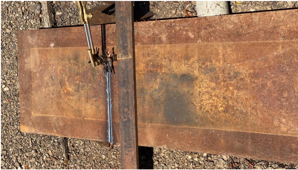
FIGURA 43. Corte de placa base para entenalla.
