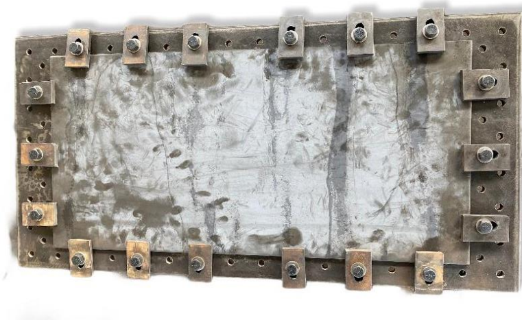
FIGURA 75. Entenalla final con la placa montada.
