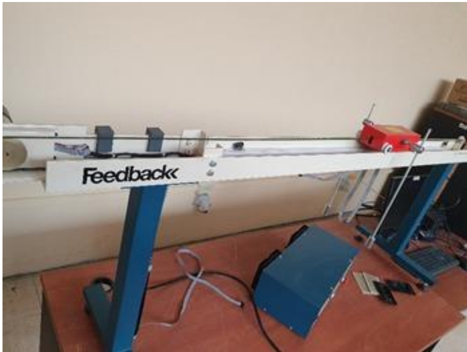
Figura 2.1 Planta de Control Péndulo Invertido Feedback 33-936IC.
