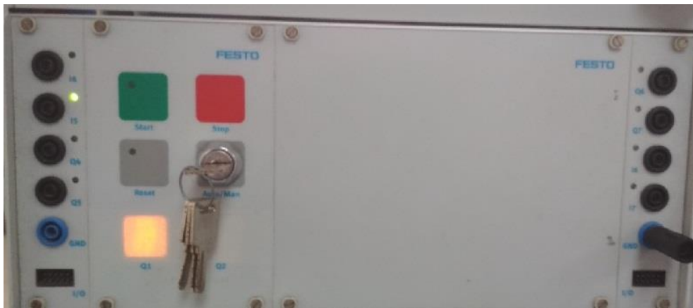
Fig. 21: Panel de Control de la estación Distribución.
