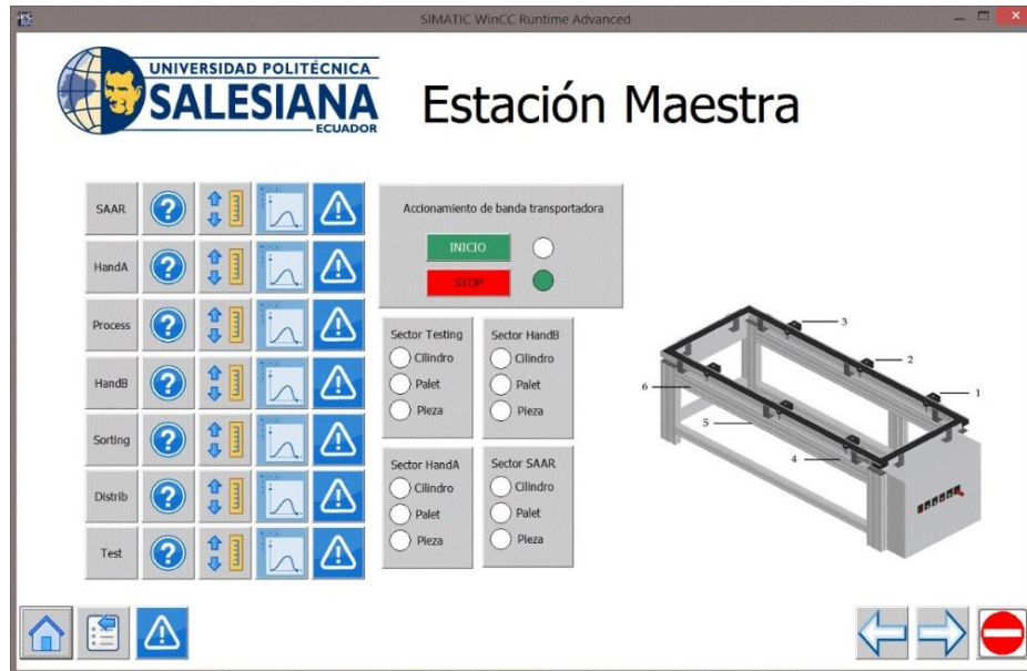
Fig. Ventana de control y monitoreo de la Banda Transportadora. 79:
