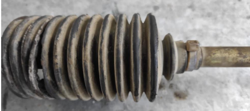
Figura 62. Guardapolvo en malas condiciones
