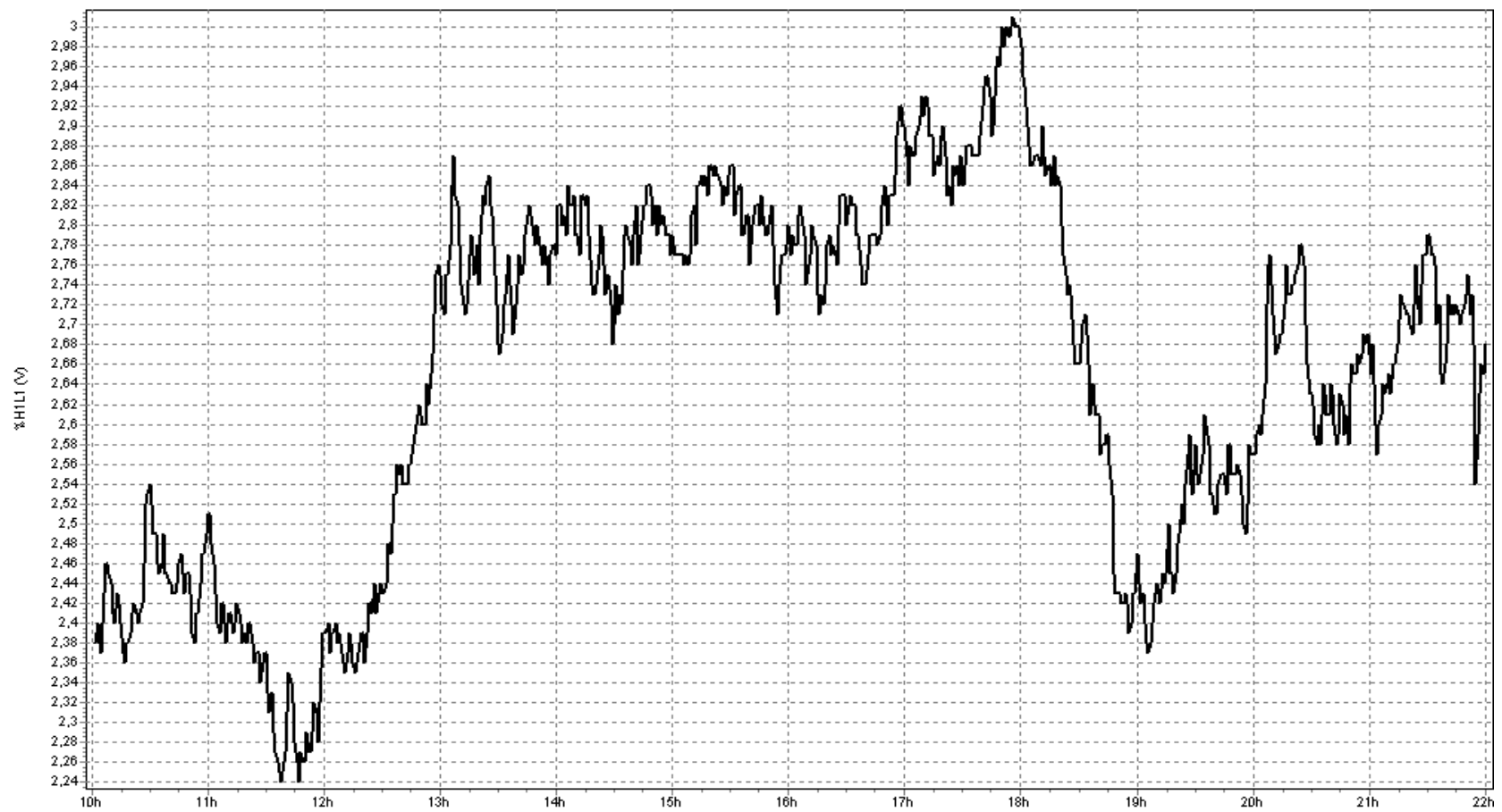
Gráfica 5.1.63 Distorsión Armónica Total de Voltaje en la Línea 1
