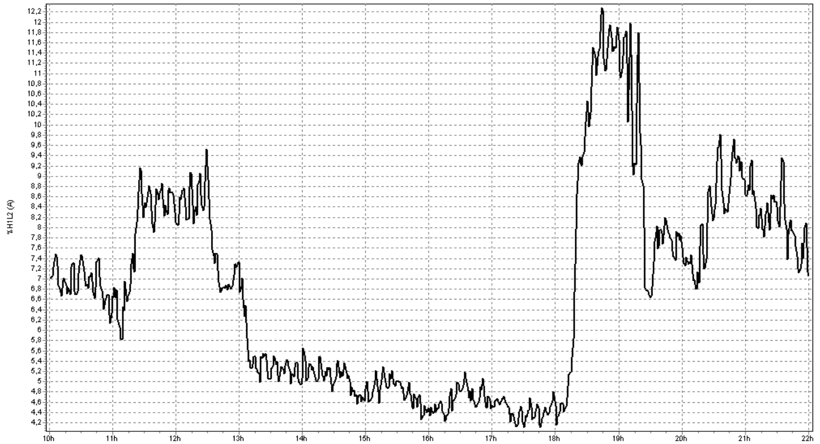
Gráfica 5.1.66 Distorsión Armónica Total de Corriente en la Línea 2
