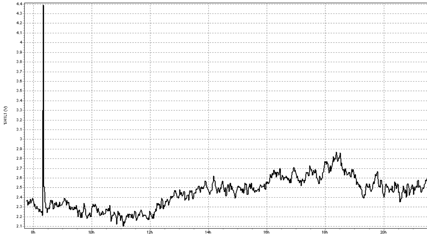
Gráfica 5.2.63 Distorsión Armónica Total de Voltaje en la Línea 1
