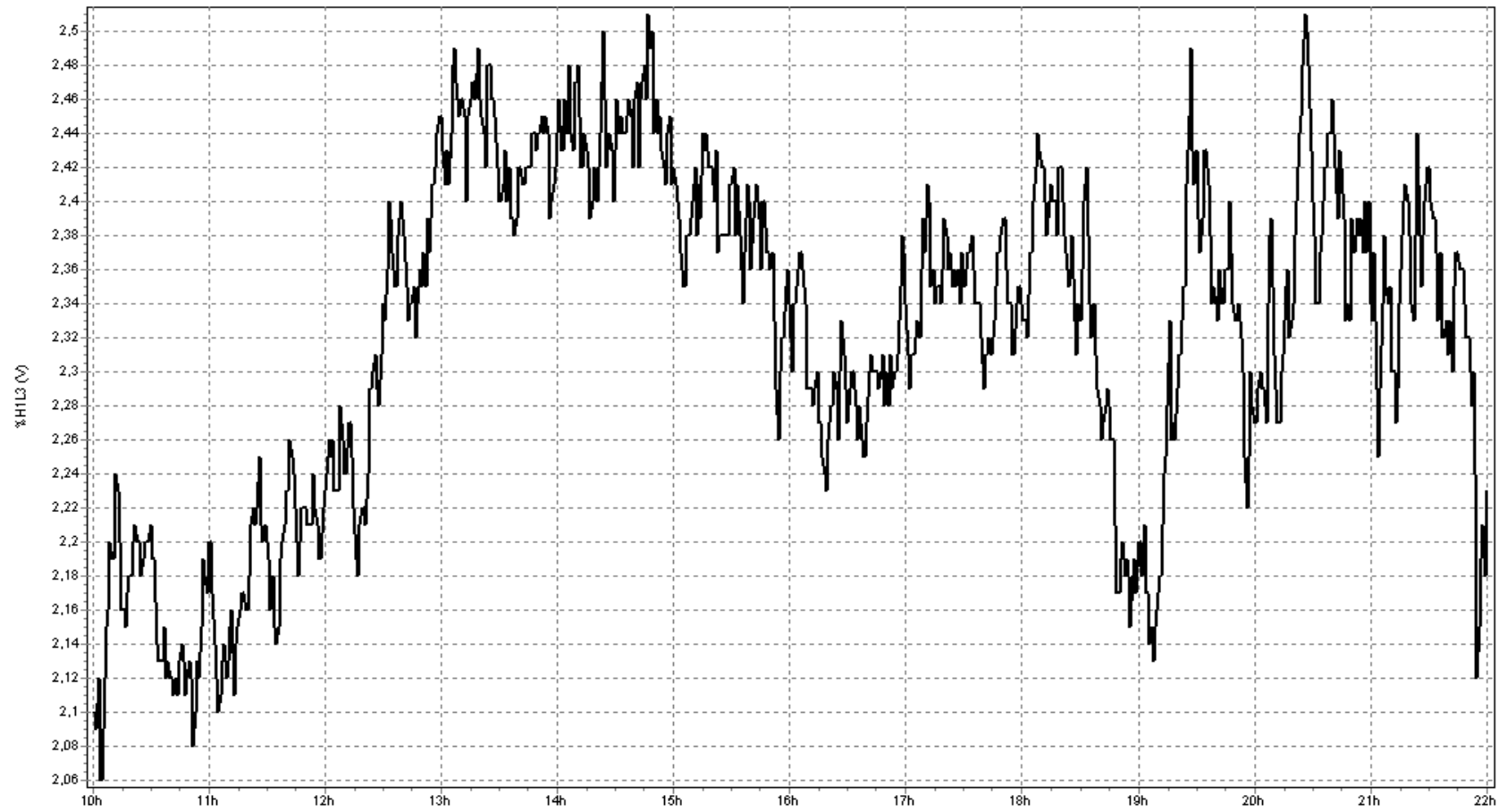
Gráfica 5.1.67 Distorsión Armónica Total de Voltaje en la Línea 3
