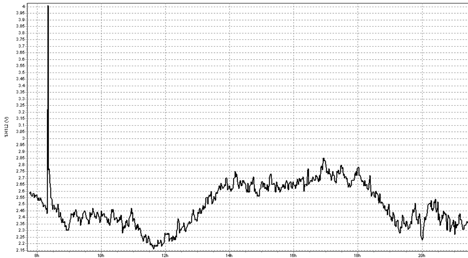
Gráfica 5.2.65 Distorsión Armónica Total de Voltaje en la Línea 2
