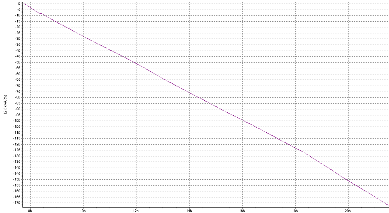
Gráfica 5.2.58 Energía Reactiva en la Línea 2 – Valor Máximo
