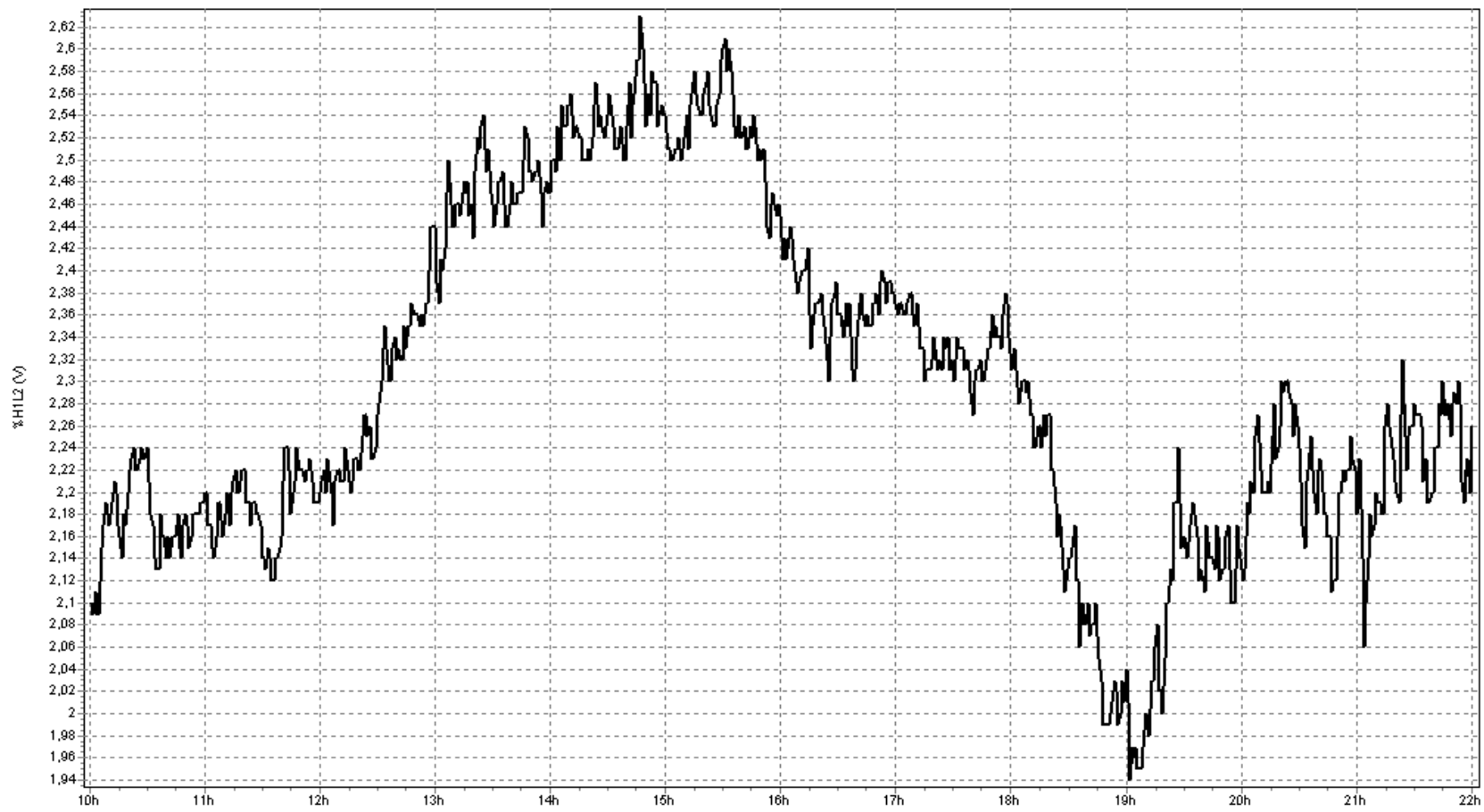
Gráfica 5.1.65 Distorsión Armónica Total de Voltaje en la Línea 2
