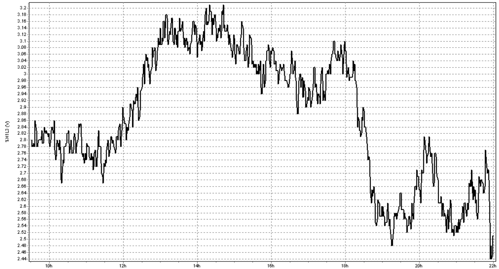
Gráfica 5.3.67 Distorsión Armónica Total de Voltaje en la Línea 3
