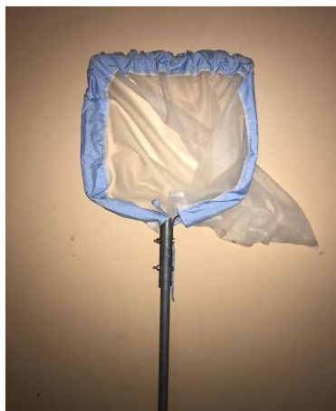
Ilustración 13 Red de mano tipo D, para la recolección de macroinvertebrados Fuente: Autora.
