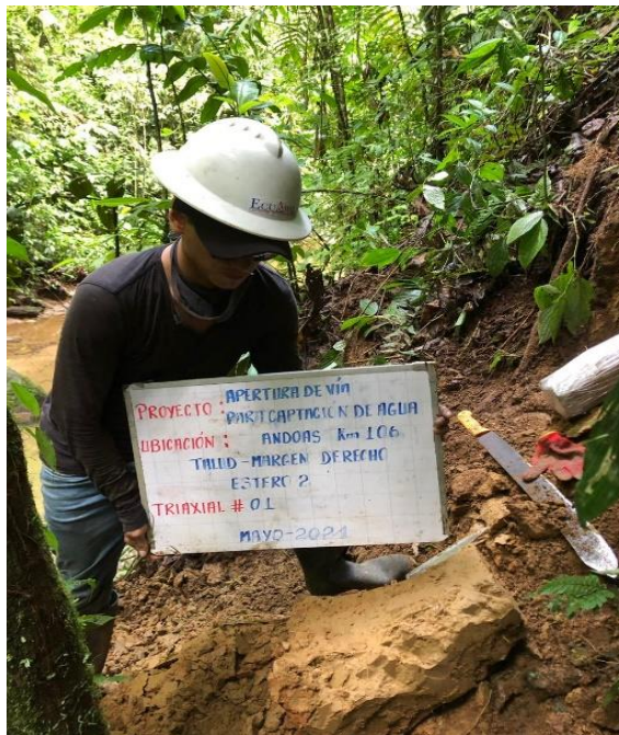
Toma de Muestra del Ensayo Triaxial
