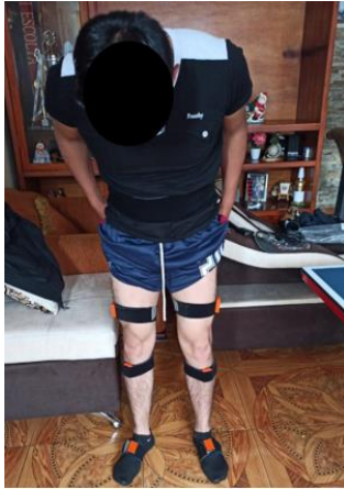
Figura 7. Ubicación de los sensores Xsens MTw Awinda para la evaluación de la marcha en un individuo con artrosis en rodilla.
