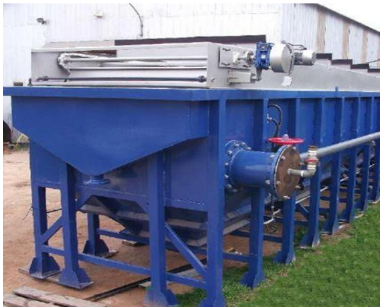
Figura 11 Equipo de flotación por aire disuelto
