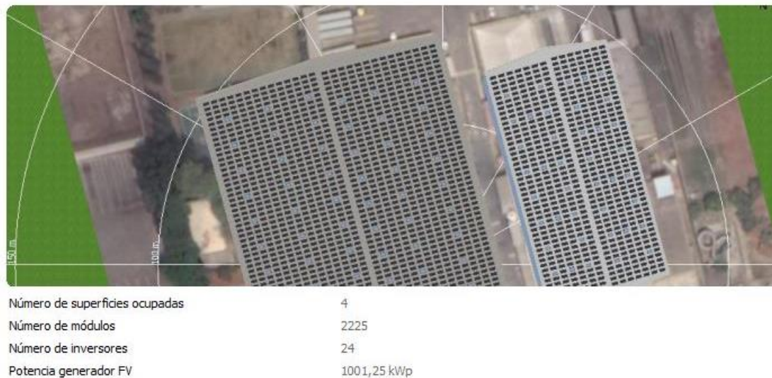
Figura 11.- Simulación de uso de paneles solares en diferentes zonas de la empresa
