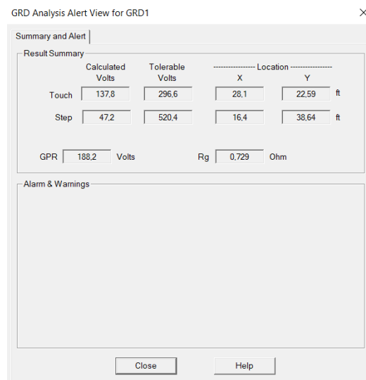
Figura 52. Valores obtenidos por simulación de las tensiones de malla y máximas tensiones admisibles al integrar la malla. Fuente: Autor
