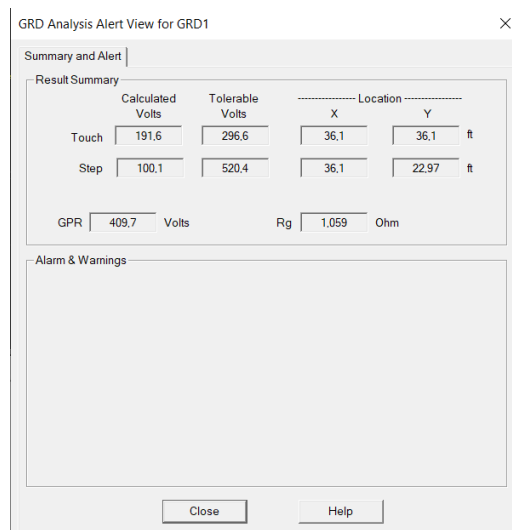
Figura 50. Valores obtenidos por simulación de las tensiones de malla y máximas tensiones admisibles. Fuente: Autor
