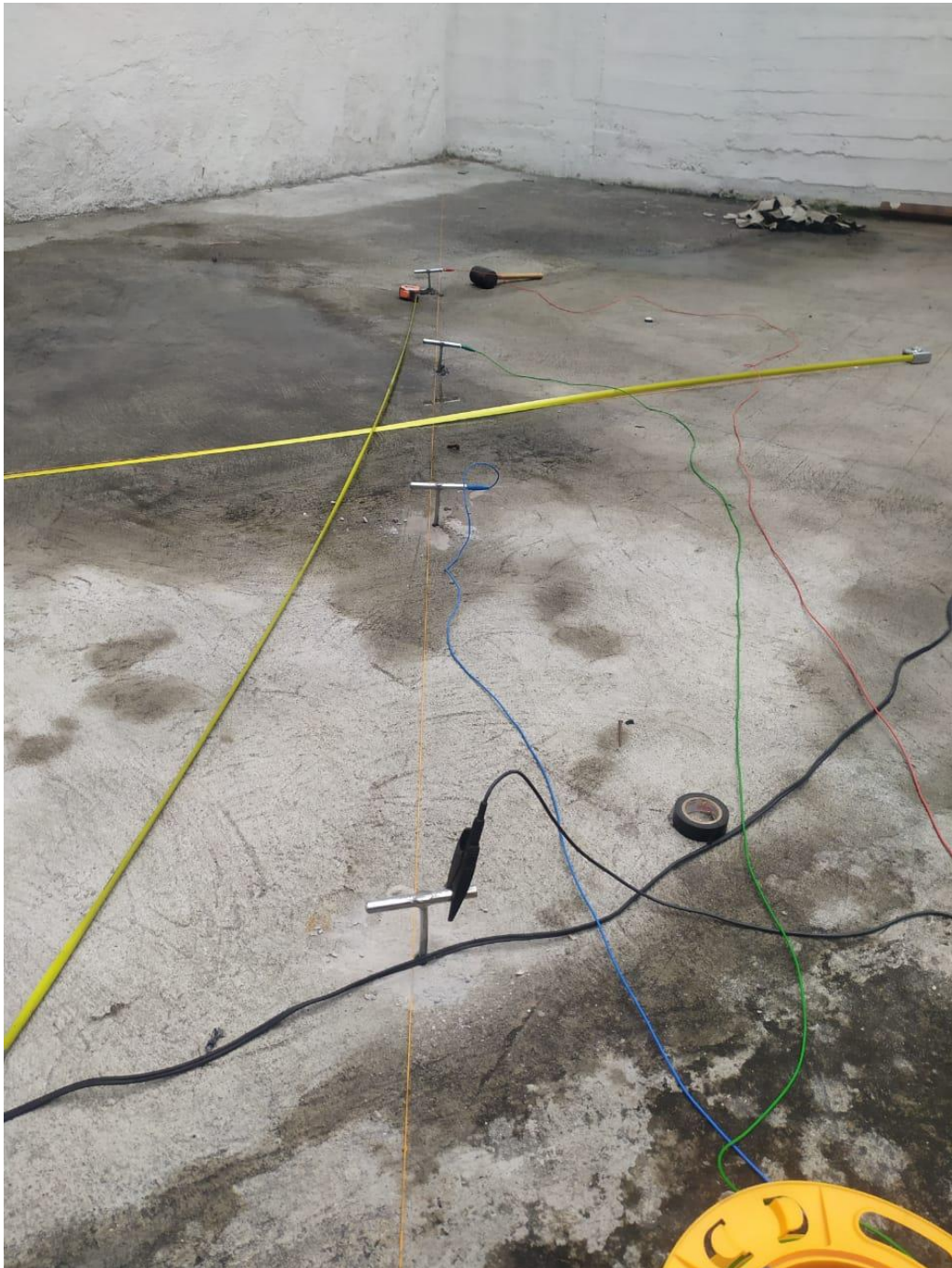
Introducción de los electrodos en los puntos marcados dentro del área delimitada.
