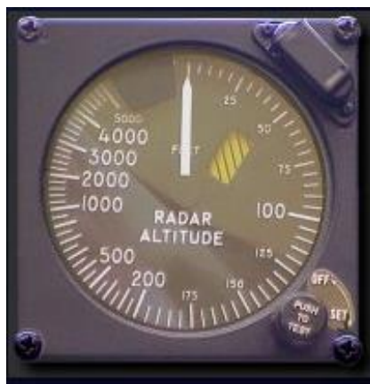
Figura 2.21 Pantalla analógica de un altímetro de radar Fuente: (radartutorial.eu, 2020)
