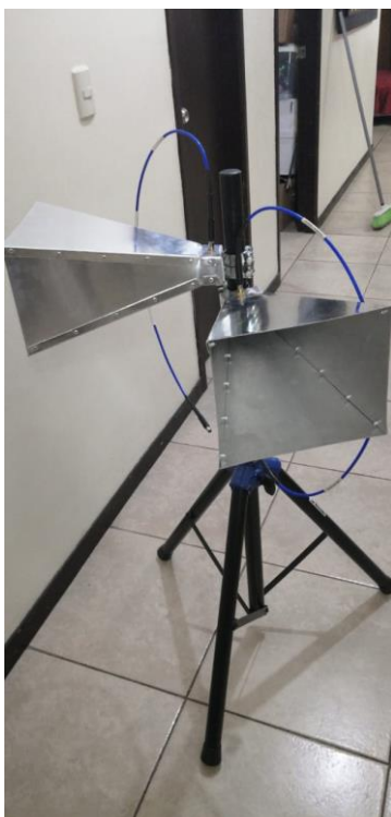
Figura 3.13 Antenas cornetas, RX y TX
