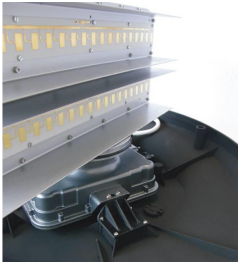
Figura 2.20 Conjunto de antenas de parche de un radar de navegación FMCW en banda X Fuente: (radartutorial.eu, 2020)
