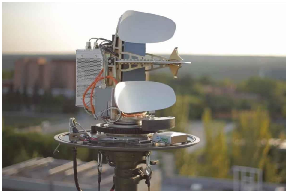
Figura 2.19 ART Midrange, un radar FMCW con antenas separadas para transmisión y recepción Fuente: (radartutorial.eu, 2020)
