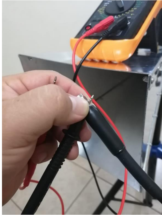
Figura 3.37 Revisión de continuidad y corto en las antenas
