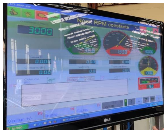
Ilustración 36 Datos del banco dinamométrico durante prueba de RPM constante
