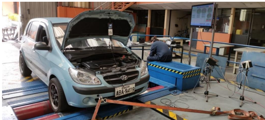
Ilustración 18 Hyundai Getz en banco dinamométrico MAHA
