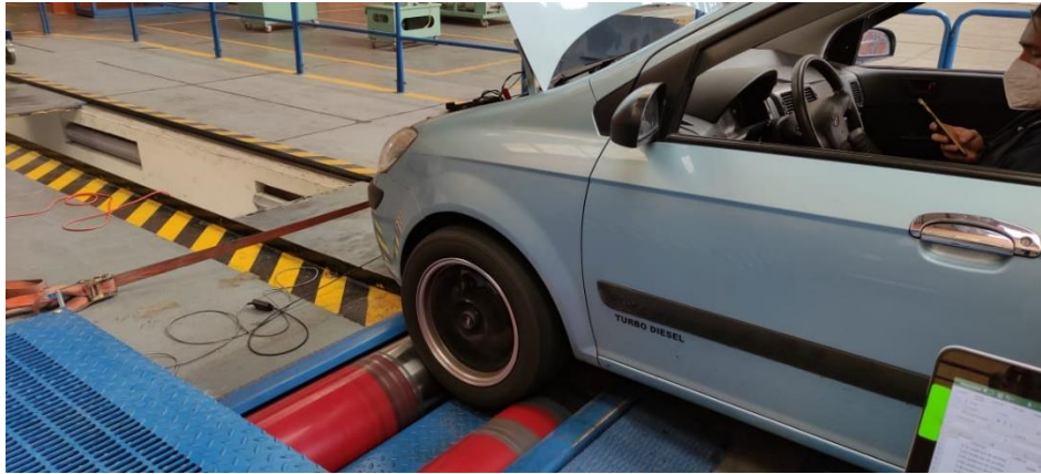
Ilustración 19 Hyundai Getz en banco dinamométrico MAHA
