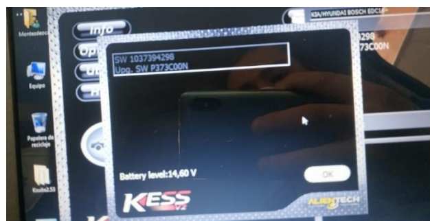
Ilustración 31 Proceso de lectura de ECU del software del dispositivo KESS v2
