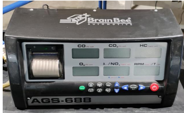
Ilustración 14 Analizador de gases
