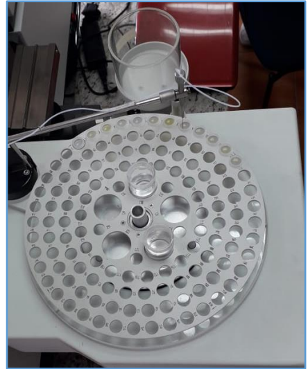
Lectura de las muestras en el Auto Sampler
