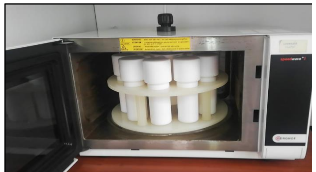
Digestión en el microondas
