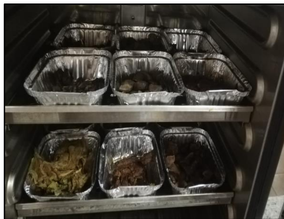
Secado de las muestras en el horno a 105 °C durante 24 horas
