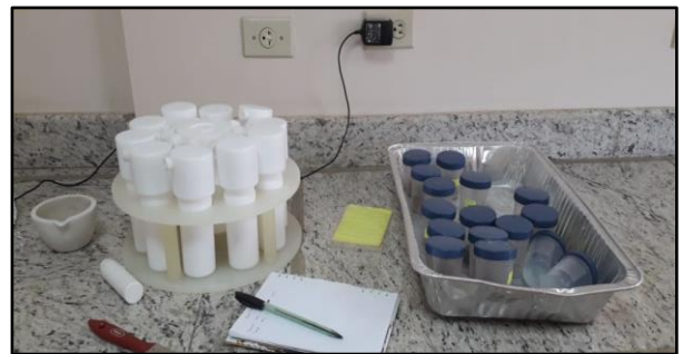
Colocación de la muestra en los recipientes de digestión antes de ingresar al microondas
