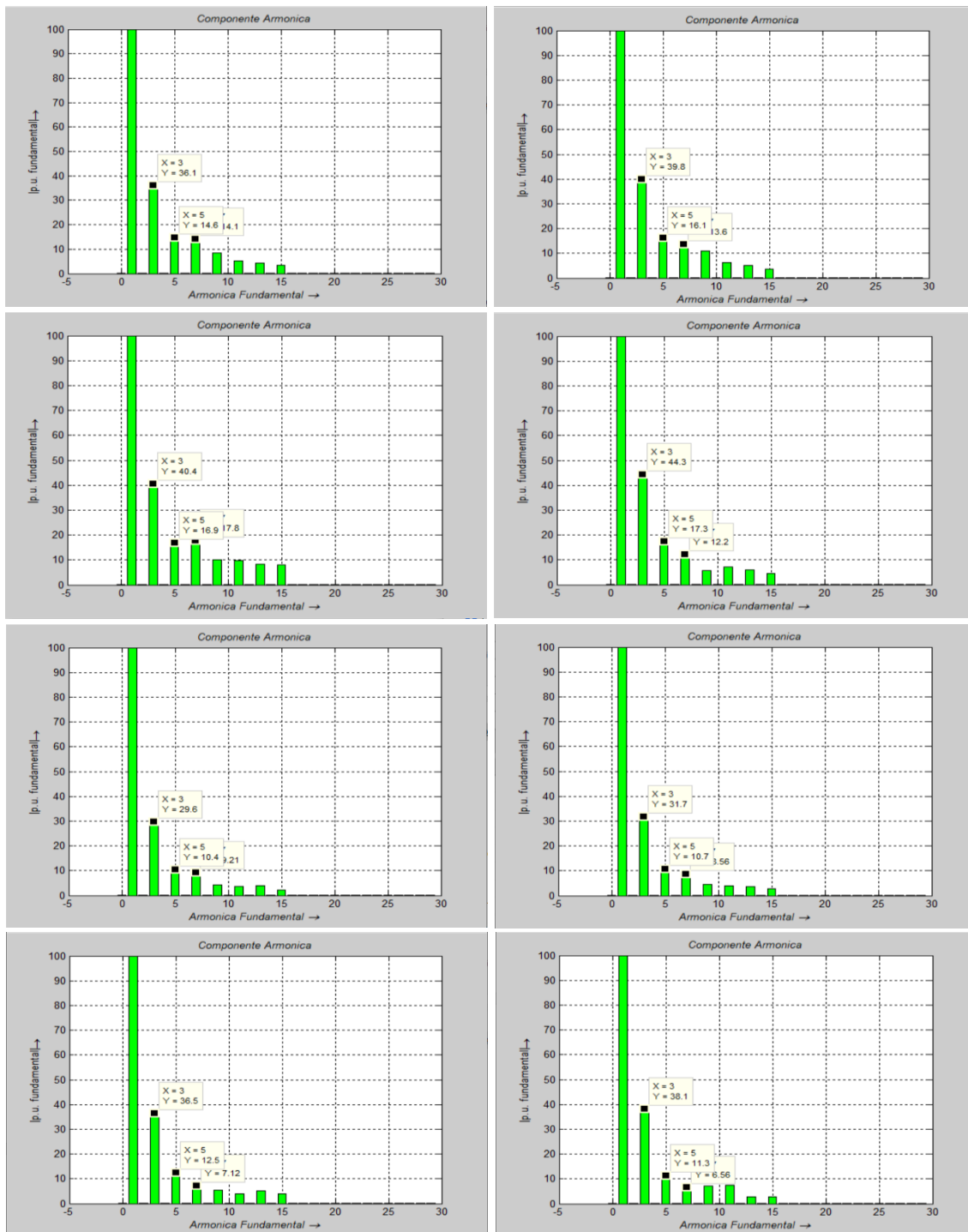
Figura 18. Armónicos de corriente de las luminarias de 6W, 12W, 18W y 24W en el tipo de luz cálida y fría.
