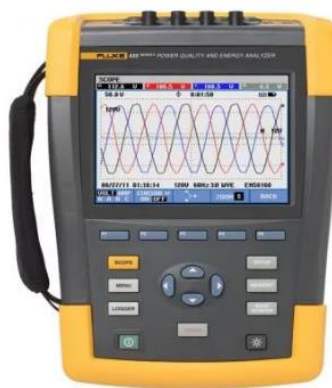
Figura 3. Analizador de redes trifásico FLUKE 435.
