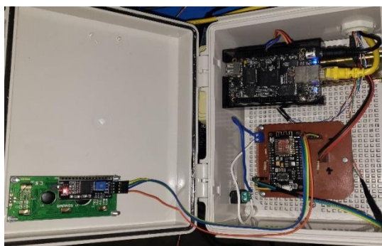
Gráfico de caja de servidor broker y placa de sensores. Elaborado por Clavijo Carlos.
