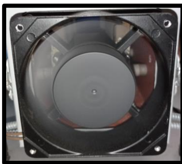
Figura 35 Ventilador 110VAC con marco metálico
