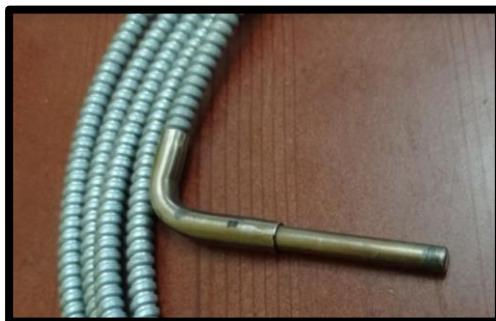
Figura 36 PT100 con recubrimiento y funda metálica de alta resistencia térmica
