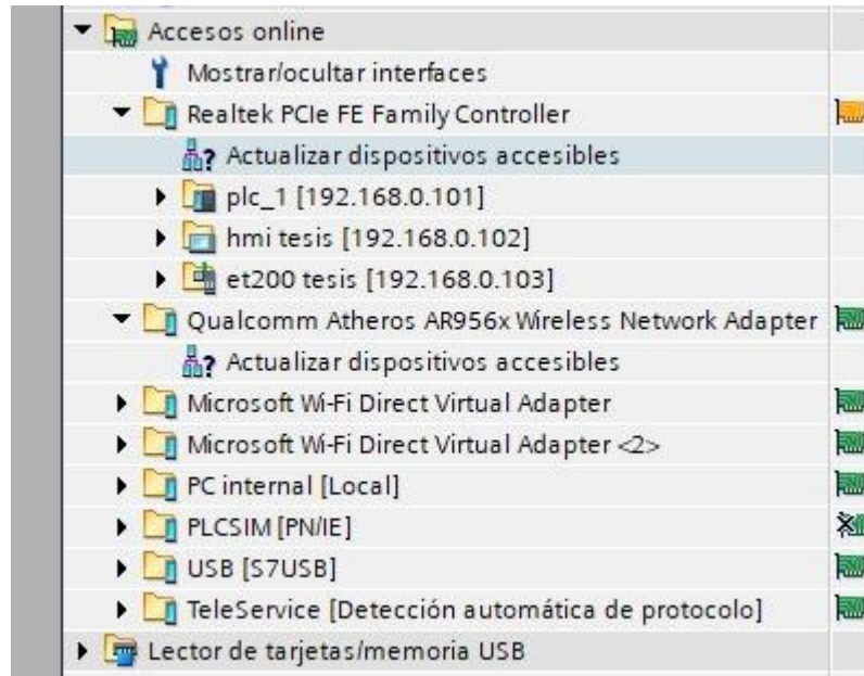
Figura 176 Tarjeta de red Wireless en Tia Portal.
