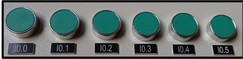
Figura 14 Botoneras rasantes de contacto normalmente abierto
