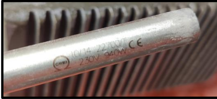
Figura 37 Resistencia tipo cartucho de 940W a 230V
