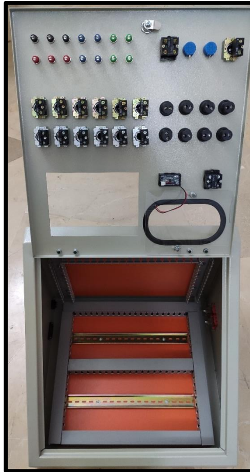
Figura 34 Módulo PLC S7-1200 previa a la implementación de los elementos.
