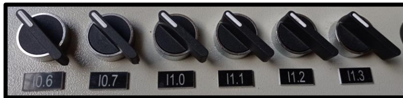
Figura 15 Selectores de dos posiciones con contactos normalmente abiertos.
