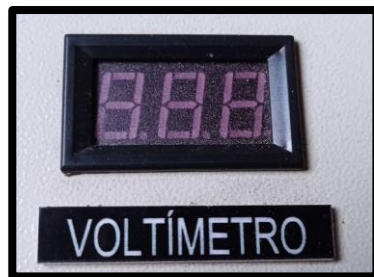
Figura 20 Voltímetro digital de panel de e dígitos
