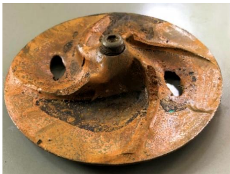
Figura 19. Erosión en impulsor a causa de la cavitación.
