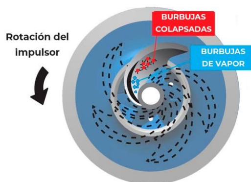
Figura 15. Etapas de implosión de una burbuja por cavitación.
