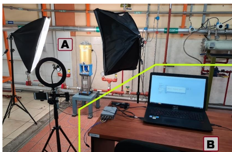
Figura 27. Banco de pruebas experimental para bomba centrífugas.
