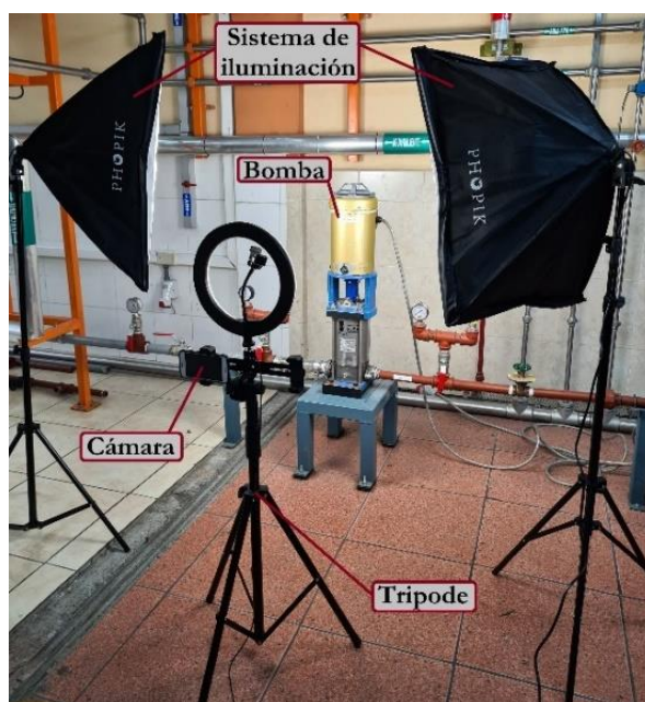
Figura 29. Sistema de iluminación del banco de pruebas experimental.
