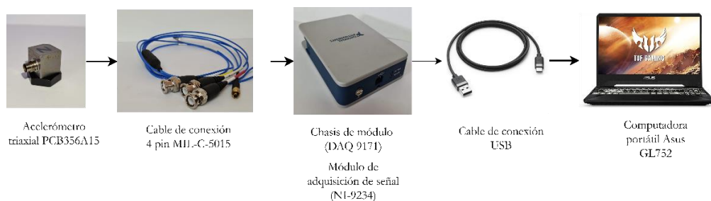
Figura 33. Secuencia de la conexión real del sistema de adquisición de señales de vibración.
