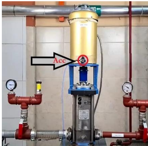
Figura 34. Ubicación acelerómetro triaxial.
