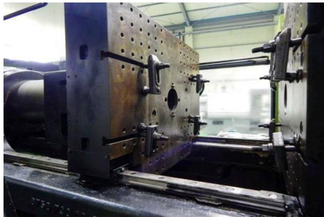
**Figura No. 11** Moldes a presión para el moldeo de frascos PET
