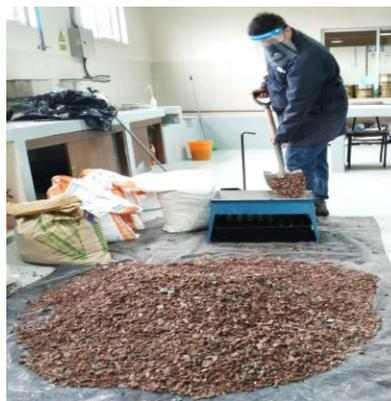
Figura 2. Homogeneización y reducción de los agregados.
