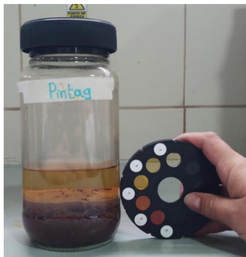
Figura 3. Prueba de impurezas inorgánicas en el agregado fino.
