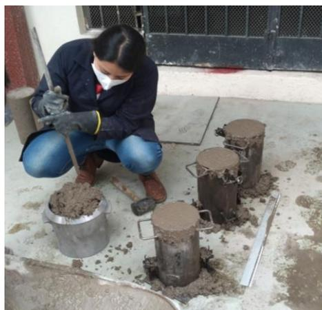
Figura 4. Moldeado de los cilindros de hormigón y toma de la muestra de concreto fresco.
