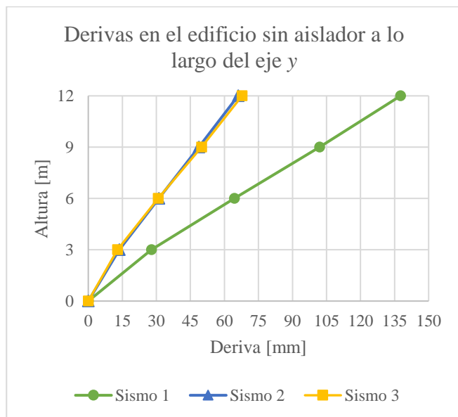
Figura 9. Derivas en el edificio sin aislador a lo largo del eje y
