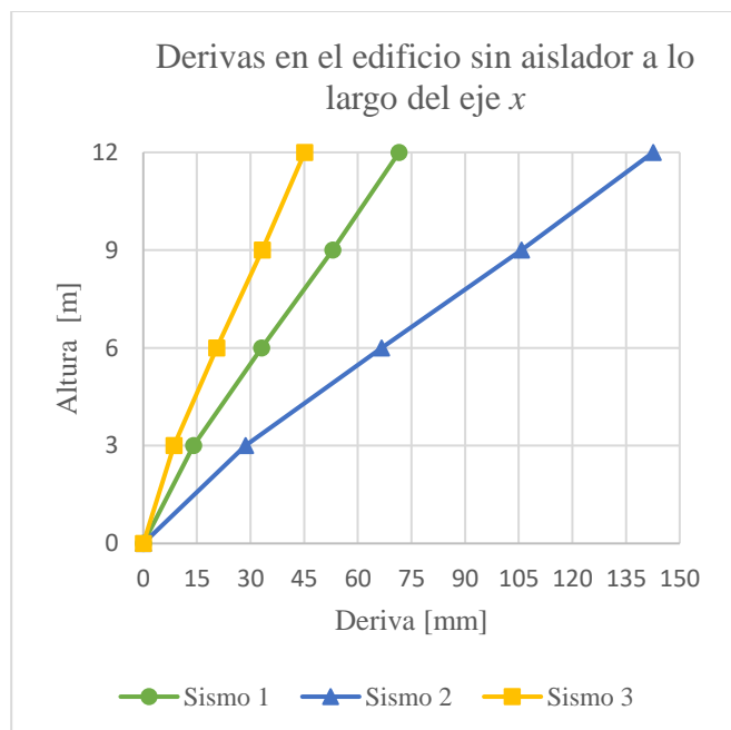
Figura 8. Derivas en el edificio sin aislador a lo largo del eje x
