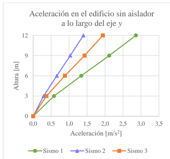
Figura 13. Aceleraciones del edificio sin aislar a lo largo del eje y
