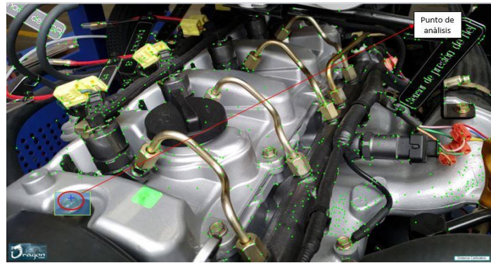
Figura 16. Motor de combustión interna con punto de análisis cargado en el software Dragon Vision. Fuente: Autores
