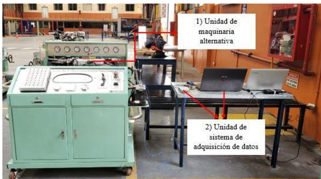
Figura 18. Banco de pruebas experimentales para MCI. Fuente: Autores
