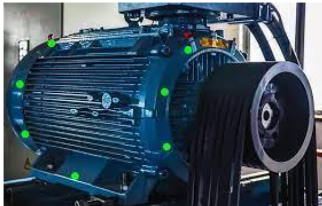
Figura 14. Técnica espejo aplicada en motor eléctrico. Fuente: (Erbessd, Software de Visualización de Vibración, 2021)
