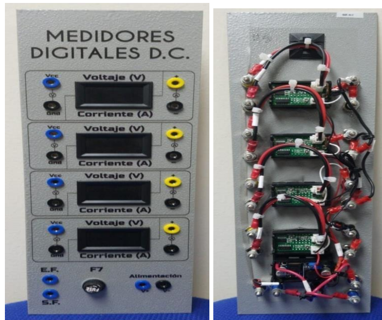
Figura 3-8. Medidores DC. Vista frontal de la lámina.
