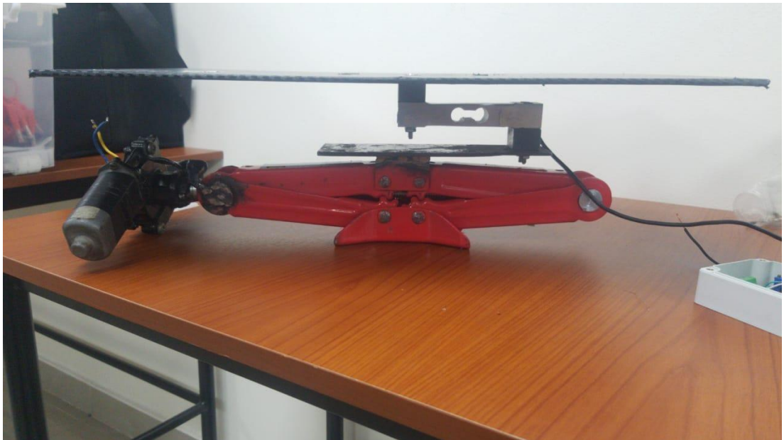
Figura A-6. Balanza interior del AVG. Vista lateral de la celda de carga.
