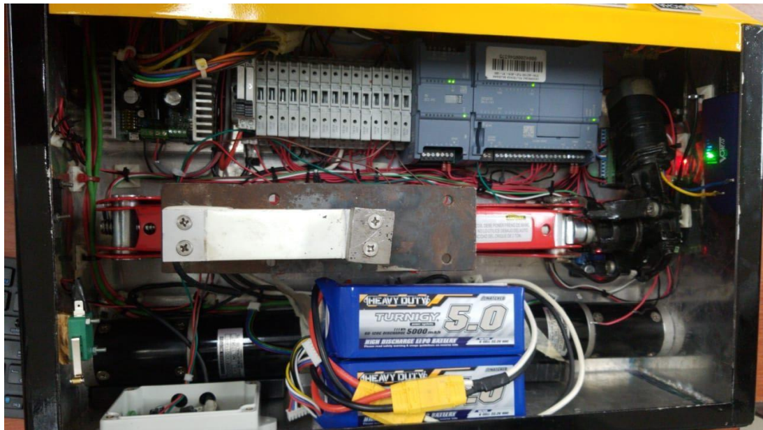
Figura A-8. Vista superior de los componentes internos del AVG.
