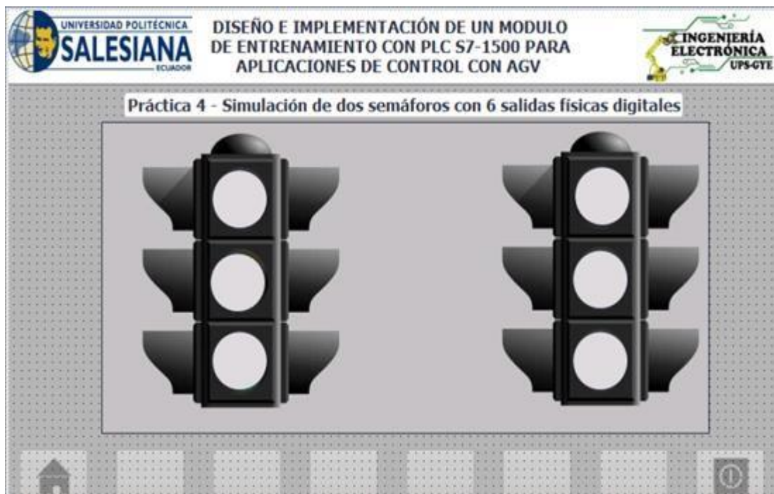
Figura 4-7. Resultados Práctica 4 – Simulación de dos semáforos con 6 salidas físicas digitales utilizando un controlador S7 1500.
