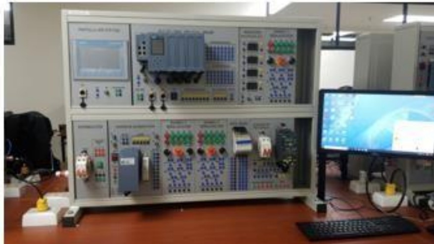
Figura 3-1. Modulo didáctico PLC S7-1500.
