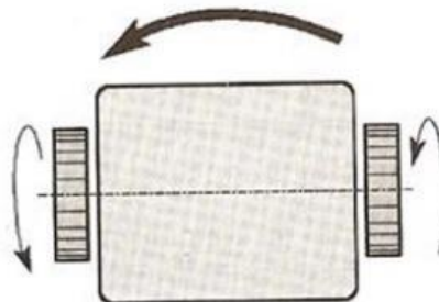
Figura 2-10. Locomoción diferencial. (Industrial, 2015)
