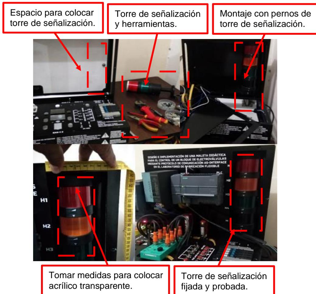
**Figura 29.** Montaje y conexión de baliza.
