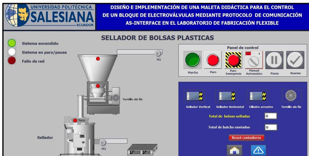
Figura 19: Sistema encendido \_ Sellador de bolsas plásticas.
