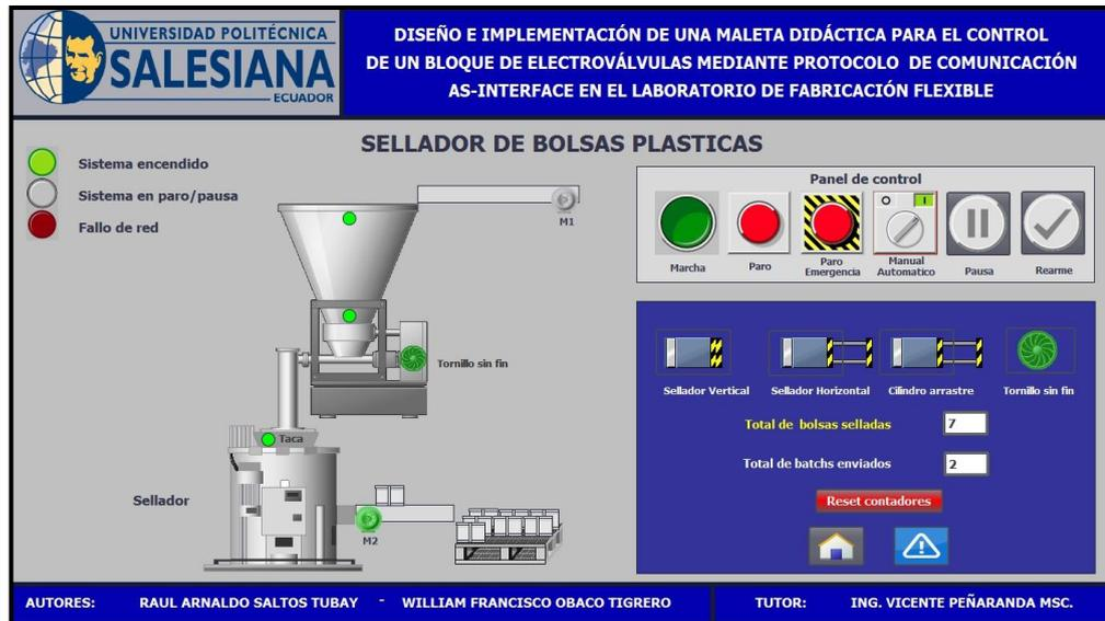
**Figura 22:** Llenado y sellado de bolsas plásticas en modo automático.
