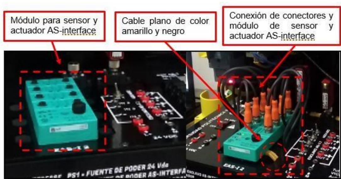
**Figura 23.** Montaje del módulo 4 I/O AS-interface para sensor y actuador
