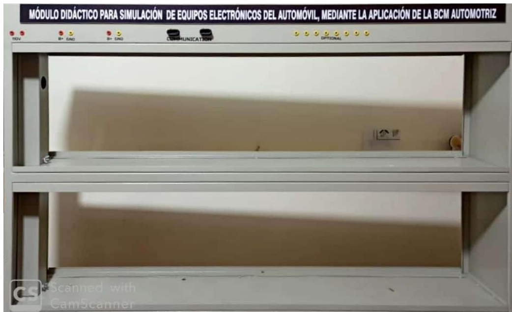
Figura 69: Estructura metalmecánica del Módulo Didáctico.
