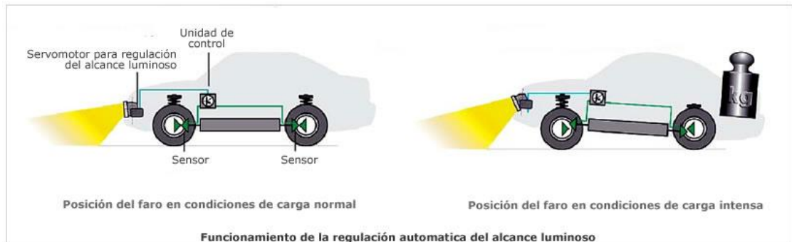
Figura 43: Funcionamiento de la regulación automática del alcance luminoso (Automotriz, 2018).
