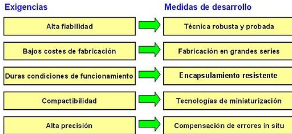
Figura 14: Particularidades de los sensores del vehículo (Medina, 2018)
