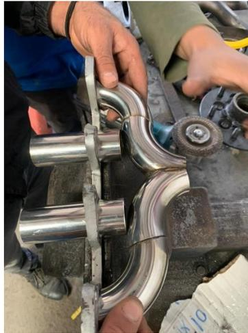
**Figura 13** Construcción del múltiple de escape
