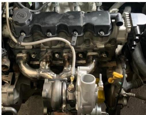
**Figura 17** Línea de lubricación del turbo
