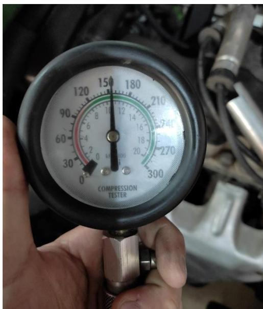
**Figura 3** *Medición de la compresión del motor*
