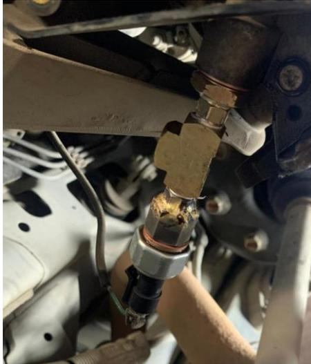
**Figura 16** Acople tipo T de cobre en el sensor de presión de aceite
