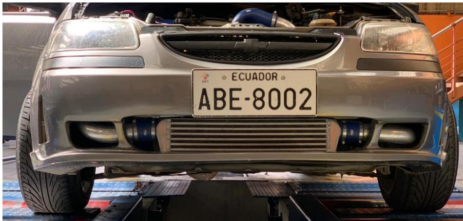
*Figura 21 Intercooler adaptado*
