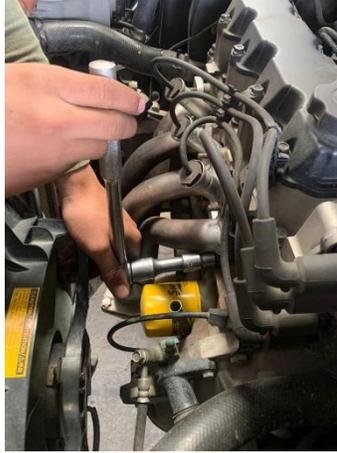
**Figura 11** *Desmontaje del colector de escape*
