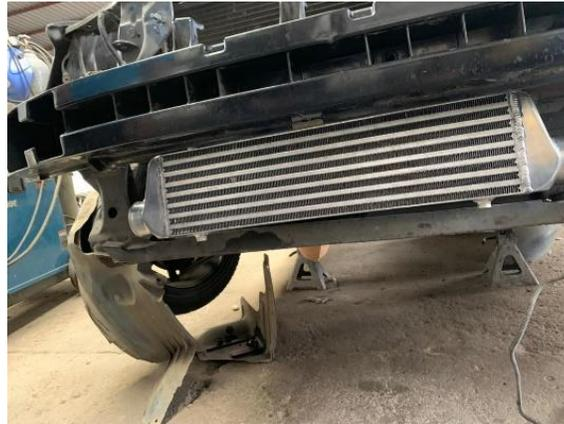
*Figura 20 Montaje del intercooler*
