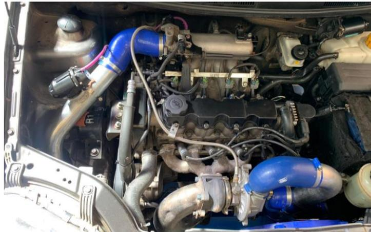
**Figura 23** *Sistema de sobrealimentación*
