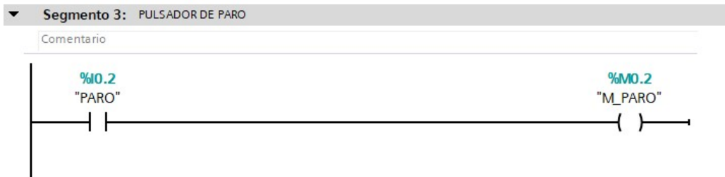
Ilustración 21. Programación del Segmento 3 en el PLC.
