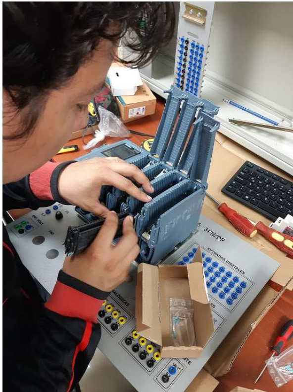
Figura 69. Instalación de los bloques de borneras por cada módulo.
