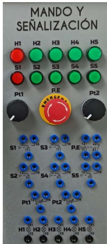
Figura 56. Lámina de mando y señalización con sus respectivos elementos.
