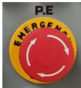
Figura 34. Paro de emergencia.
