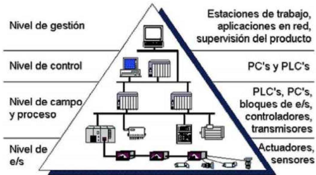
Figura 6. Niveles de comunicación en el entorno industrial (Hurtado, s.f.).
