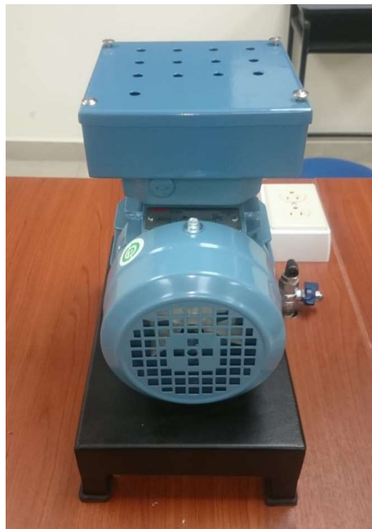
Figura 23. Motor ABB Trifásico.
