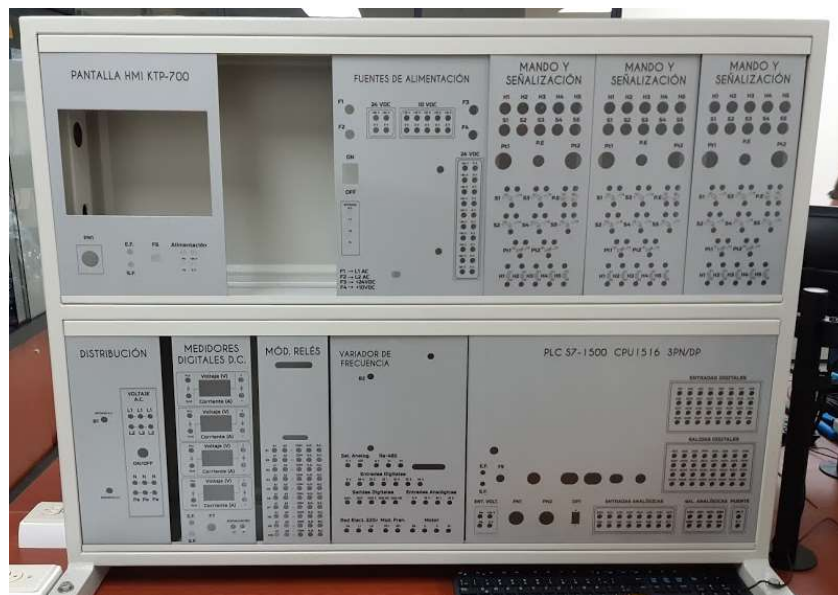
Figura 76. Instalación de las láminas con serigrafía en el módulo.
