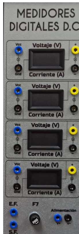
Figura 59. Lámina con medidores digitales instalados.
