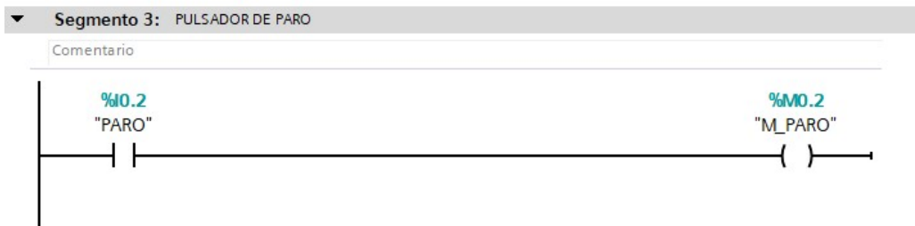
Ilustración 21. Programación del Segmento 3 en el PLC.
