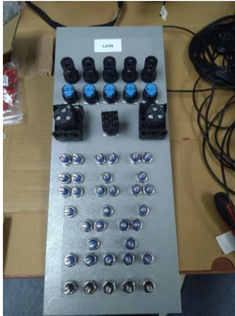
Figura 58. Vista posterior de lámina de mando y señalización.
