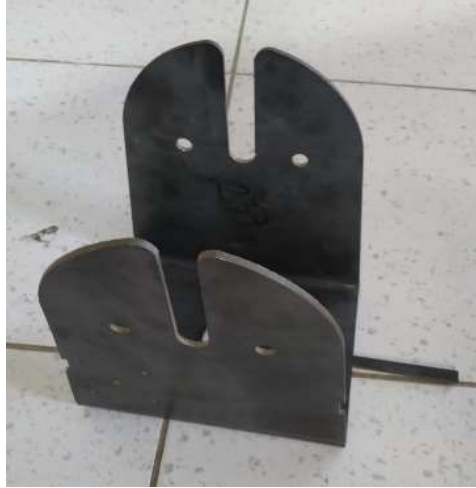
Figura 86. Soporte de elevación (chapa metálica)
