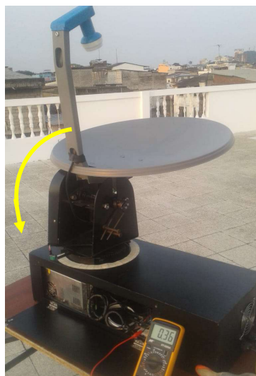
Figura 98. Apuntamiento de la antena al cenit y sentido de la dirección a moverse
