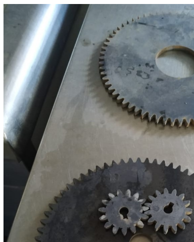
Figura 85. Engranajes y piñones (corte por chorro de agua)
