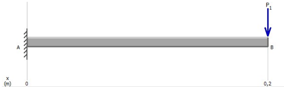
Figura 23. Carga de viga en voladizo MDsolids
