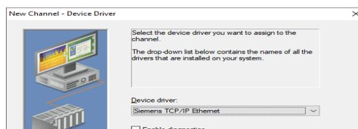
Figura 8.12 Configuración de “Device driver”.
