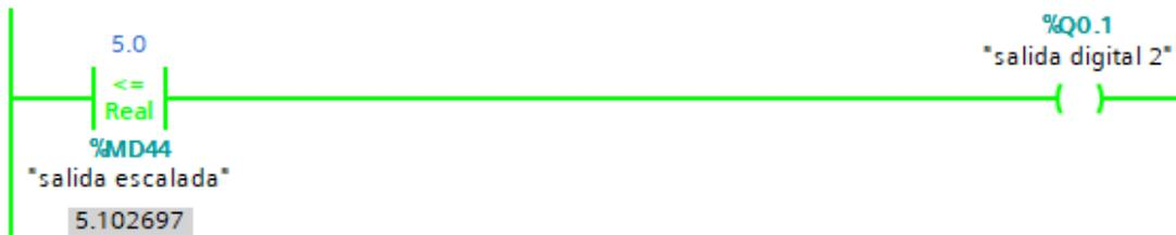
Figura 3.16 Comparador analiza el valor de SETPOINT=5 y Salida Escalad=5.1, Salda digital 2 ON
