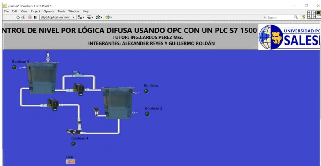
Figura 9.68 Ventana “Front Panel” con los indicadores LED.
