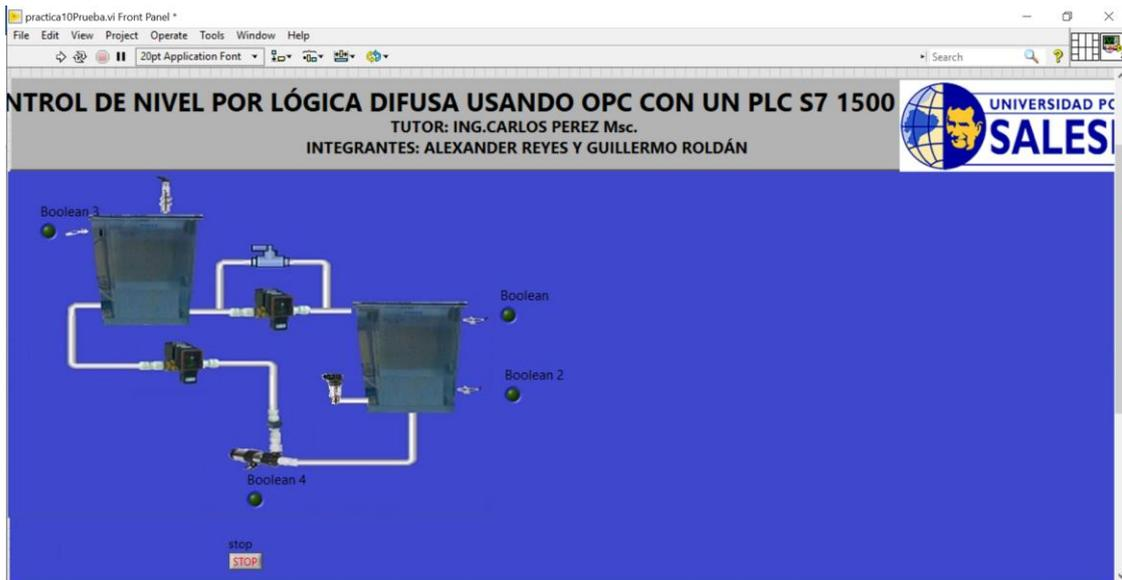
Figura 10.97 Ventana "Front Panel" con los indicadores LED.
