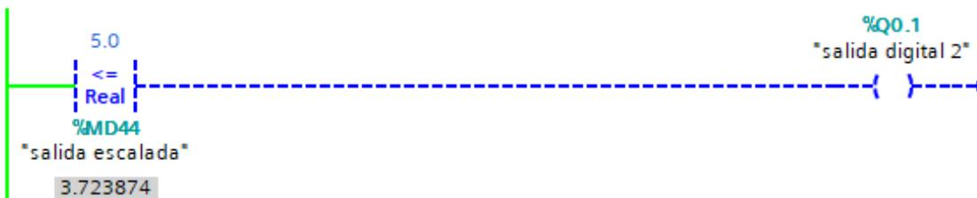
Figura 3.15 Comparador analiza el valor de SETPOINT=5 y Salida Escalad=3.7
