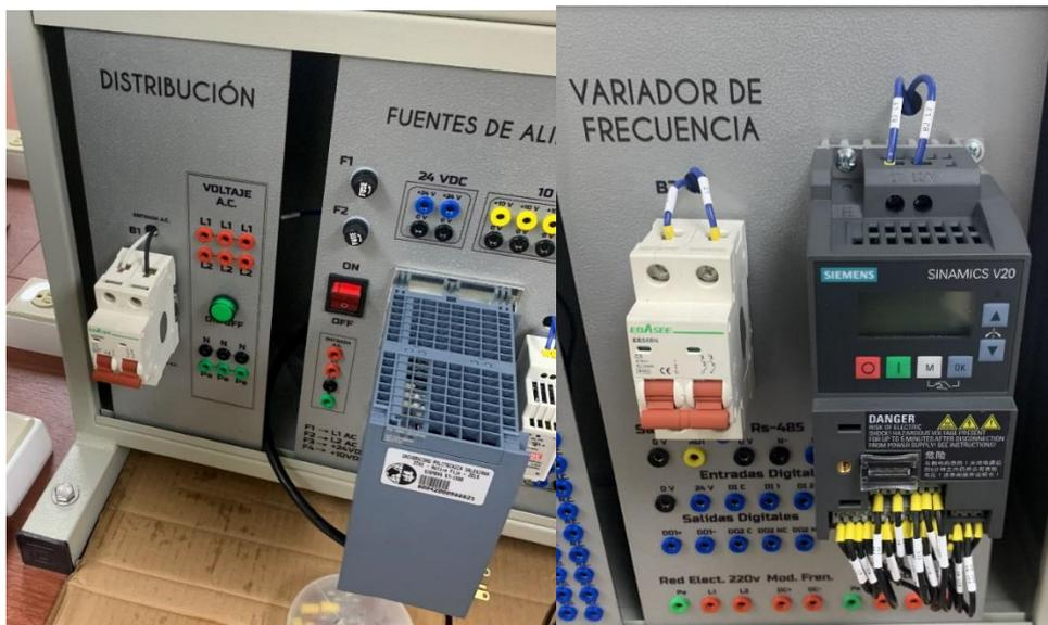
Figura 13. a) Distribución y Fuente de alimentación b) Módulo de variador de frecuencia
