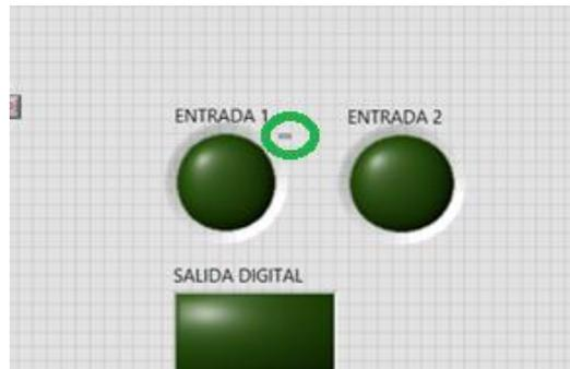
Figura 8.54 Variable de LabVIEW con data binding agregado.
