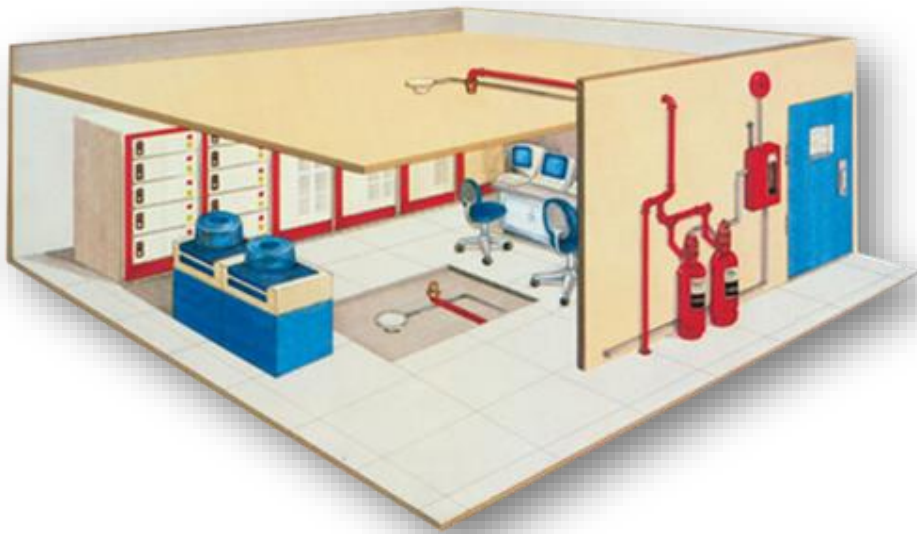
Figura 58: Sistema automatizado de sofocación en los cuartos eléctricos
