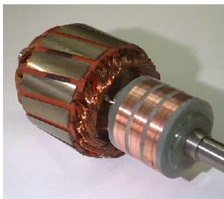
Figura 2.8: Rotor devanado con anillos deslizantes [33]
