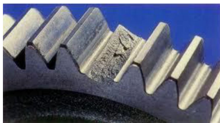
Figura 2.5: Engranaje recto con rotura de diente, condición severa [25]
