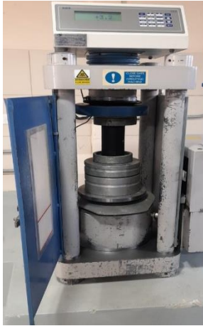
Figura 3. Ensayo a compresión.
