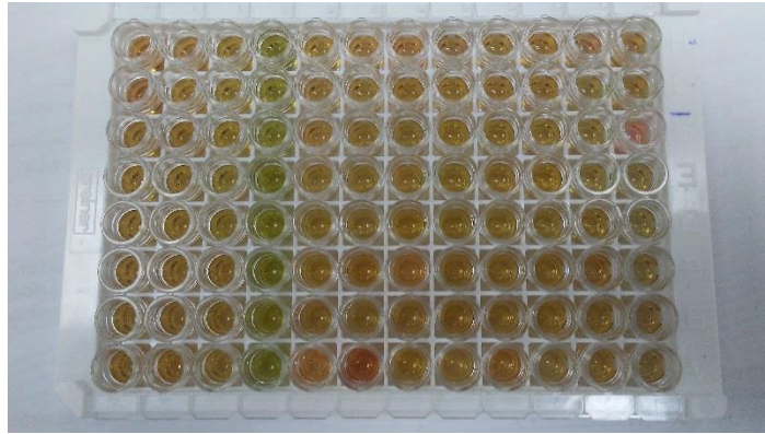
Foto 9. Lector de microplacas se lee la absorvancia a 450nm.
