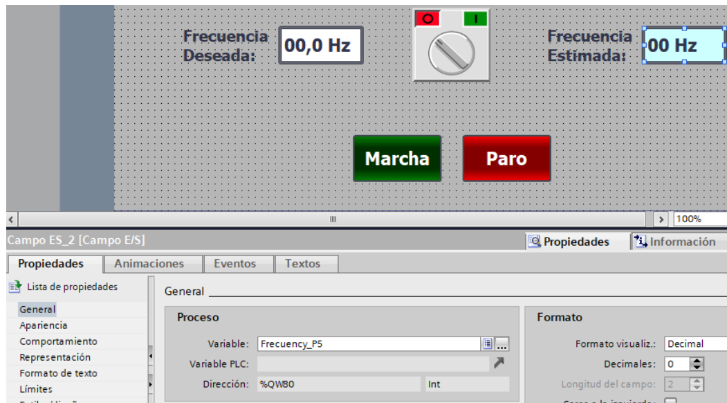
Figura 88. Campo de salida para frecuencia aplicada al variador – P5.
