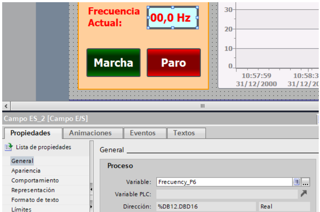
Figura 106. Campo de salida para frecuencia aplicada al motor – P6
