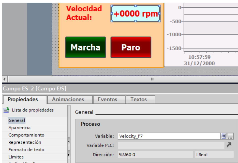
Figura 126. Campo de salida para frecuencia aplicada al motor – P7
