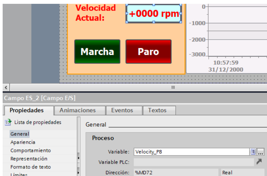
Figura 143. Campo de salida para frecuencia aplicada al motor – P8
