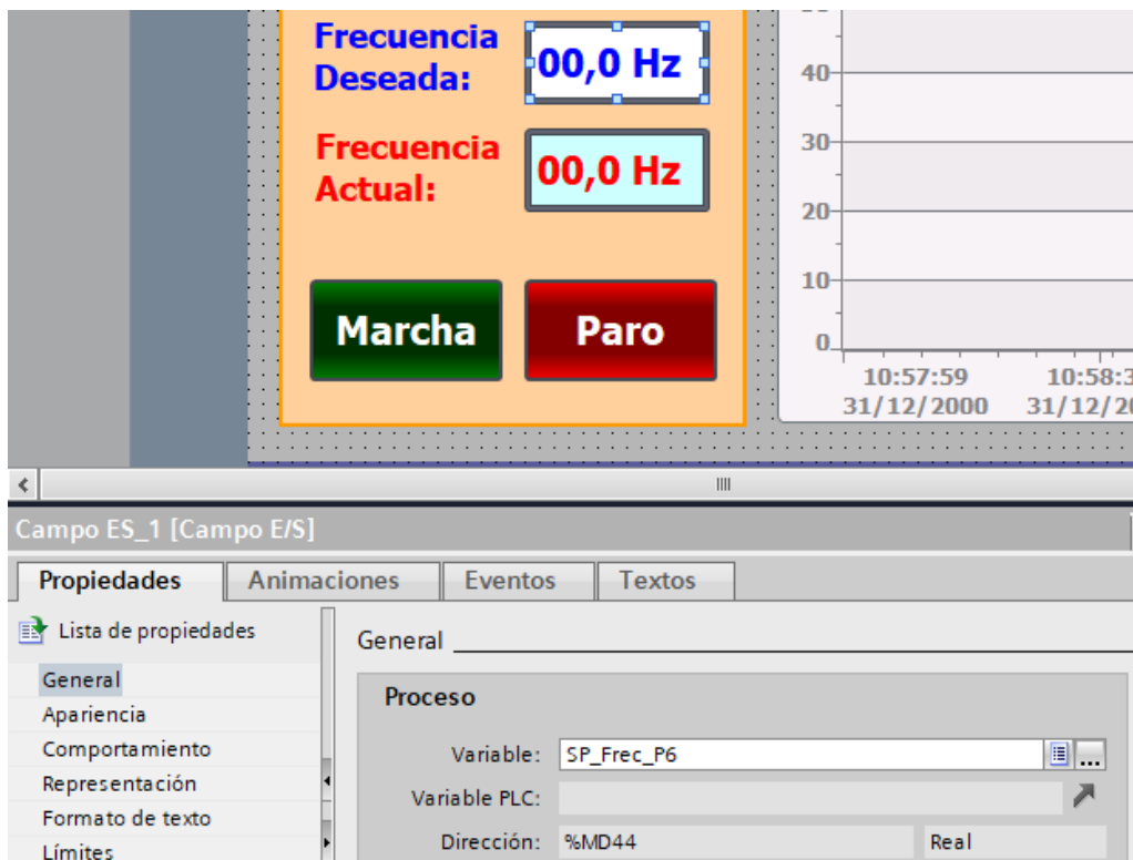
Figura 105. Campo de entrada/salida para fijar la frecuencia – P6
