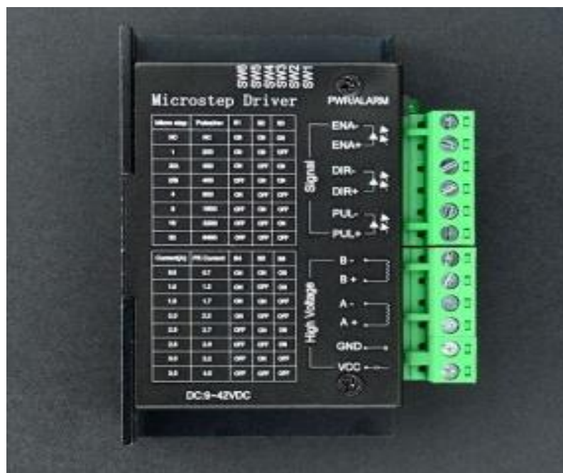
Ilustración 22: Controlador de motores paso a paso 3.5A (TB6600)[22].
