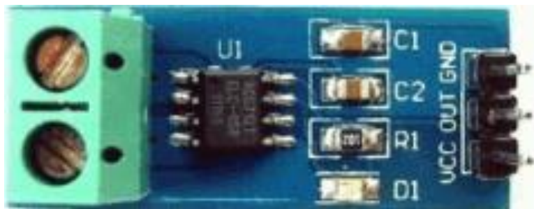
Ilustración 23: Sensor de Corriente ACS712[23].
