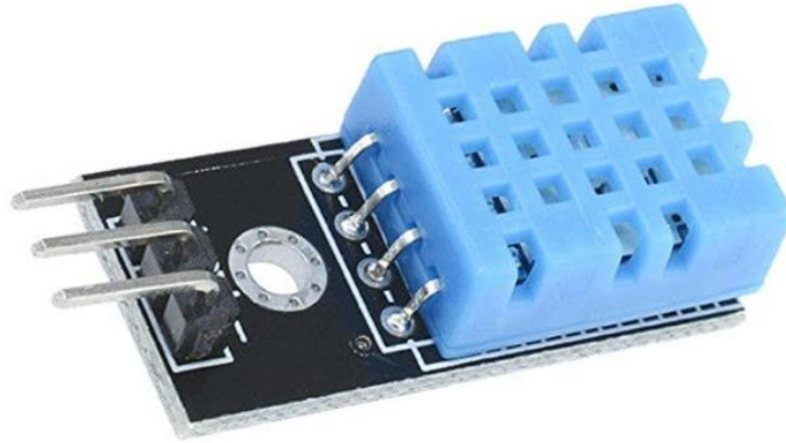
Ilustración 24: Sensor de temperatura[24]
