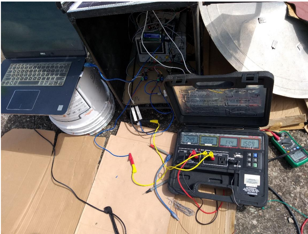
Ilustración 38: Prueba de los sensores de corriente y voltaje con el vatímetro.
