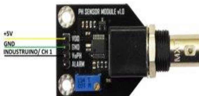
Figura 40. Conexión entre el Sensor de pH1 Y el industruino
