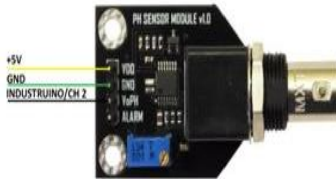
Figura 41. Conexión entre el Sensor de pH2 Y el industruino
