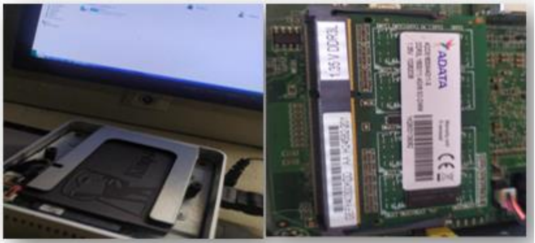
Figura 44. Instalación de disco sólido de 120GB Y memoria RAM DDR3L 1600Hz 4GB.
