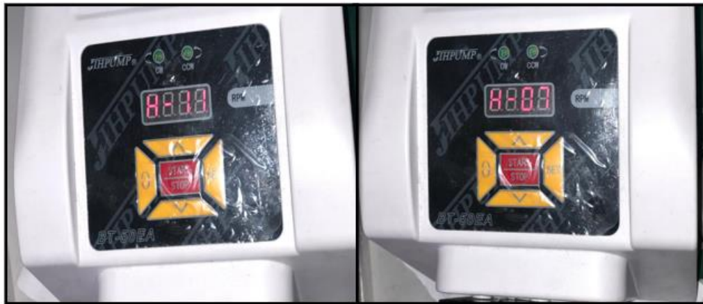
Figura 49. Configuración en (H-07 Y H-11) para control externo
