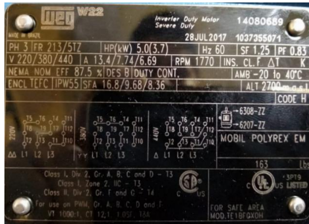
Figura 13. Datos de placa de la máquina de inducción Fuente: UPS.
