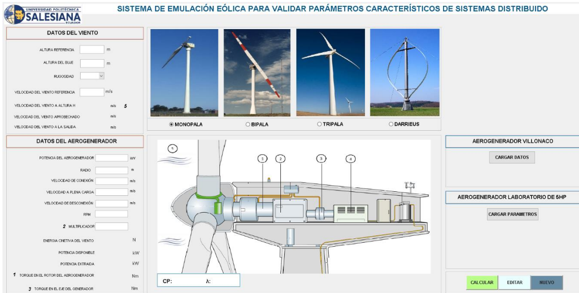
Figura 18. Sistema de emulación eólica Fuente: [Autor].
