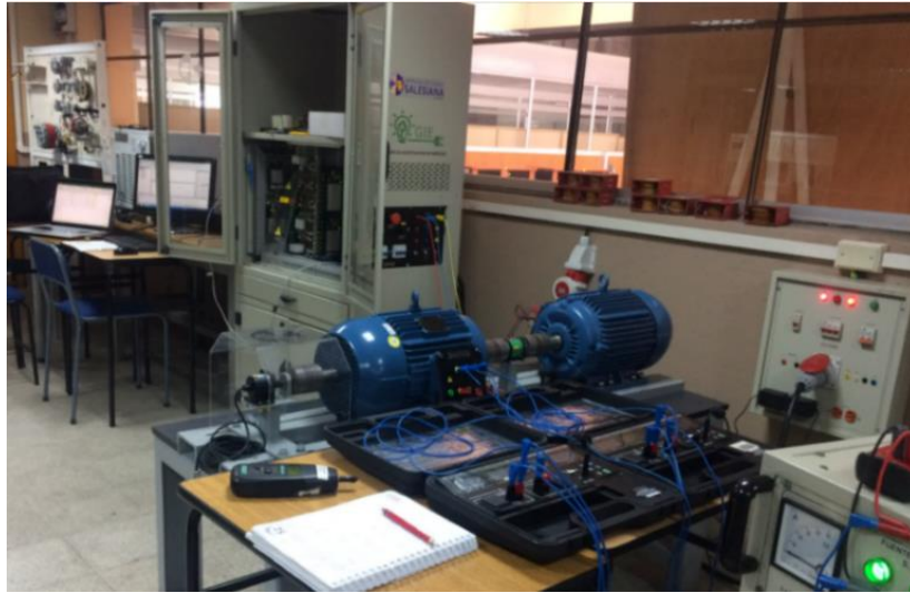
Figura 30. Conexión de los instrumentos para la adquisición de datos. Fuente: [UPS].
