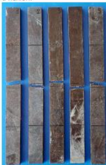
Figura 9. Condiciones finales de las probetas F-20%-1 a F-20%-5 (MS-21-084 a MS-21-088) después de los ensayos de resistencia a flexión tomando como referencia la norma ASTM D7264/D7264 M-15.
