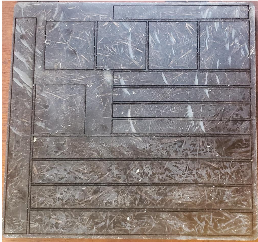
Figura 40. Corte láser terminado, dando lugar a las probetas requeridas
