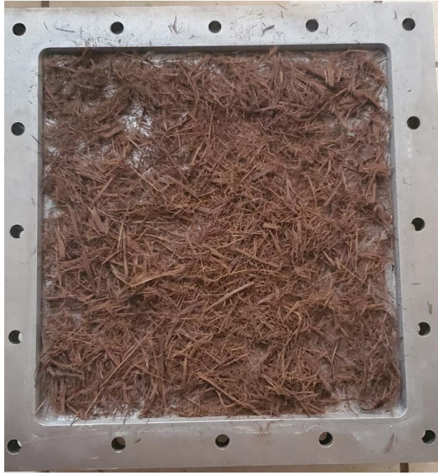
Figura 35. Distribución de la fibra en el molde
