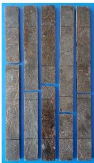
Figura 5. Condiciones finales de las probetas T-20%-1 a T-20%-5 (MS-21-064 a MS-21-068) después de los ensayos de resistencia a tracción tomando como referencia la norma ASTM D3039/D3039 M-17.
