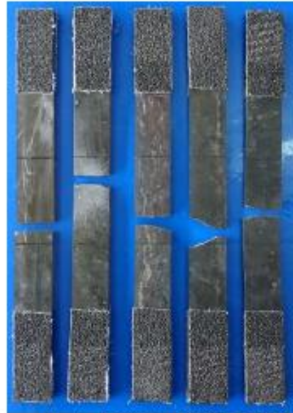
Figura 3. Condiciones finales de las probetas T-0%-1 a T-0%-5 (MS-21-054 a MS-21-058) después de los ensayos de resistencia a tracción tomando como referencia la norma ASTM D3039/D3039 M-17.
