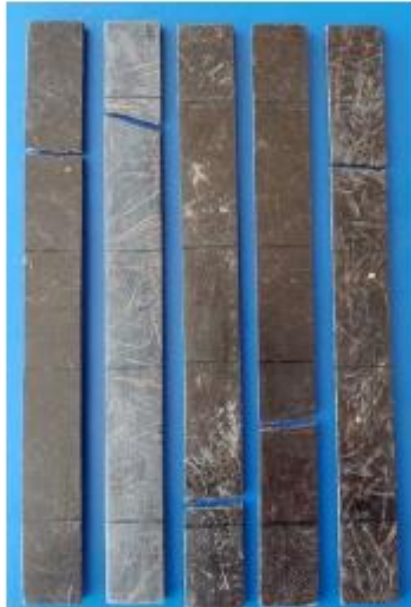
Figura 6. Condiciones finales de las probetas T-30%-1 a T-30%-5 (MS-21-069 a MS-21-073) después de los ensayos de resistencia a tracción tomando como referencia la norma ASTM D3039/D3039 M-17.
