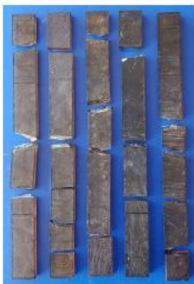
Figura 7. Condiciones finales de las probetas F-0%-1 a F-0%-5 (MS-21-074 a MS-21-078) después de los ensayos de resistencia a flexión tomando como referencia la norma ASTM D7264/D7264 M-15.
