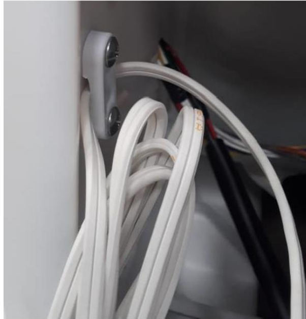
Figura 52. Brida acoplado a un refrigerador[18]
