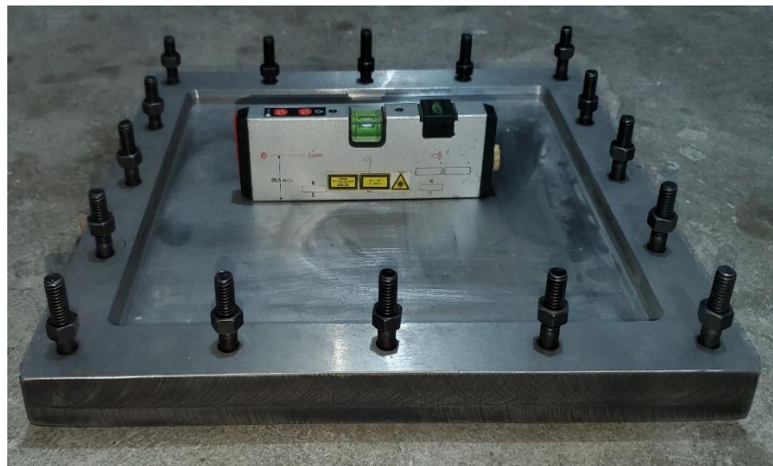
Figura 33. El nivel se toma en los 2 sentidos de las burbujas indicadoras para que no exista error de medida
