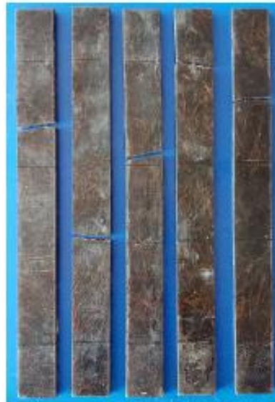
Figura 4. Condiciones finales de las probetas T-10%-1 a T-10%-5 (MS-21-059 a MS-21-063) después de los ensayos de resistencia a tracción tomando como referencia la norma ASTM D3039/D3039 M-17.
