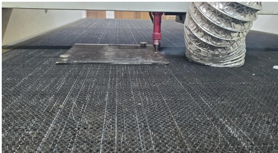
Figura 39. Corte láser de las planchas del material compuesto
