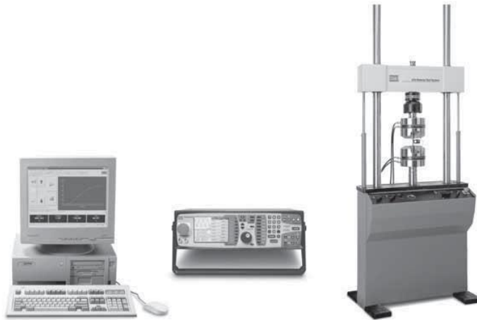
Figura 16. Máquina para ensayos de tensión con sistema automático de procesamiento de datos[48]
