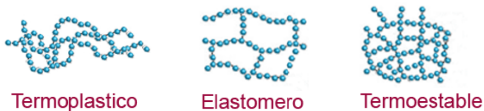
Figura 4. Estructura molecular de las matrices poliméricas [16]
