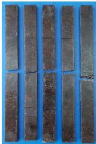
Figura 8. Condiciones finales de las probetas F-10%-1 a F-10%-5 (MS-21-079 a MS-21-083) después de los ensayos de resistencia a flexión tomando como referencia la norma ASTM D7264/D7264 M-15.
