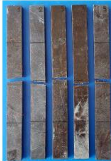
Figura 10. Condiciones finales de las probetas F-30%-1 a F-30%-5 (MS-21-089 a MS-21-093) después de los ensayos de resistencia a flexión tomando como referencia la norma ASTM D7264/D7264 M-15.
