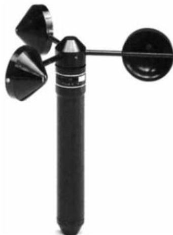
Figura 2.1 Anemómetro de rotación de tres cazoletas (Carta, 2009).
