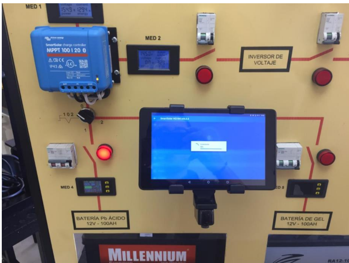
Figura 9. Módulo del sistema aislado con los cambios realizados.
