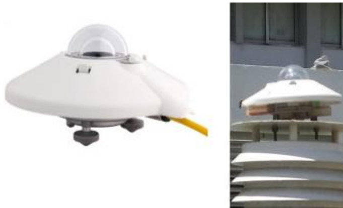
Figura 2. Piranómetros CMP 3 para mediciones de irradiancia global.
