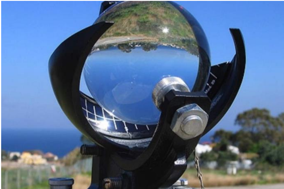
Figura 3. Heliógrafo para medir la insolación.
