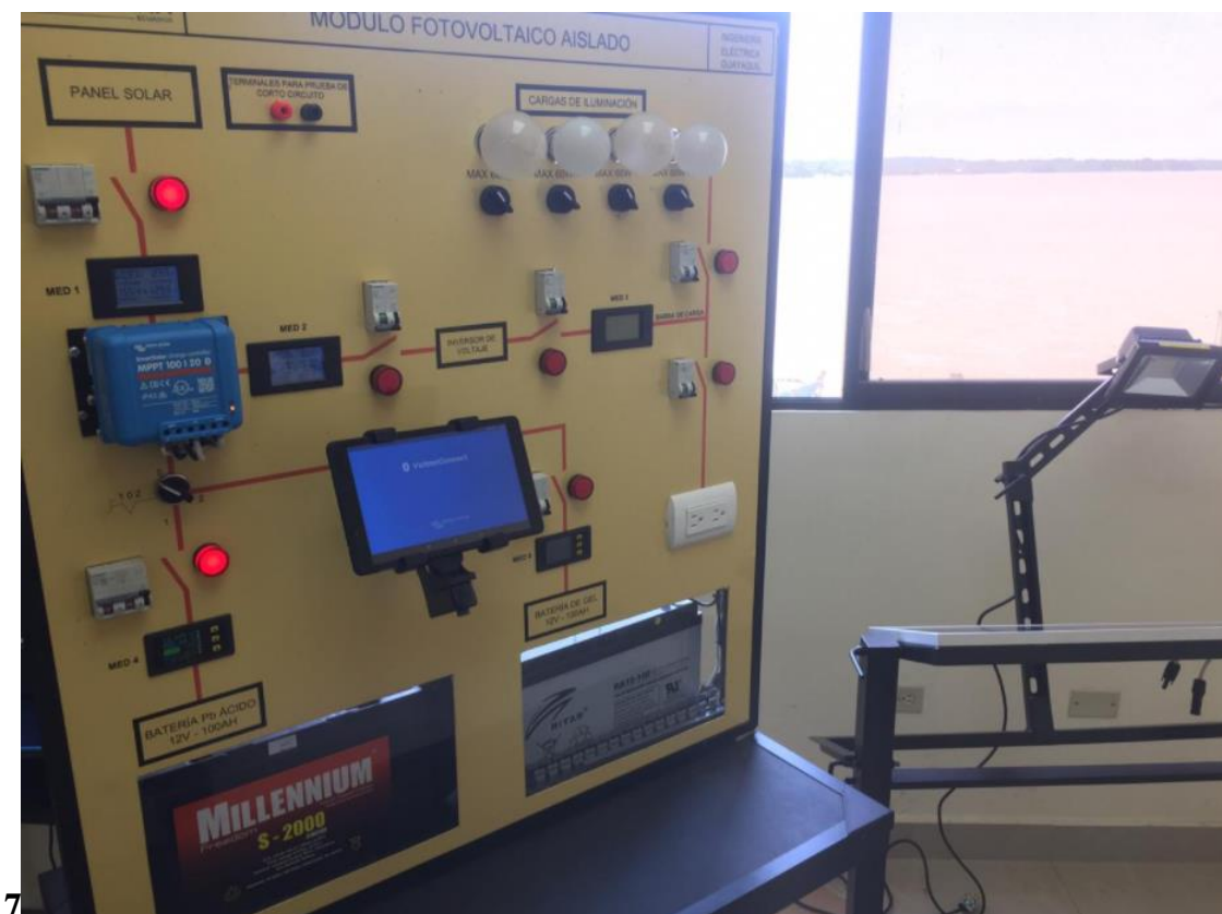
Figura 10. Modulo fotovoltaico aislado junto al seguidor solar
