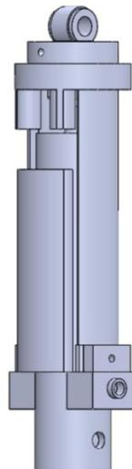
Figura 63 Sujeción del pistón hidráulico al mecanismo. Fuente Autor
