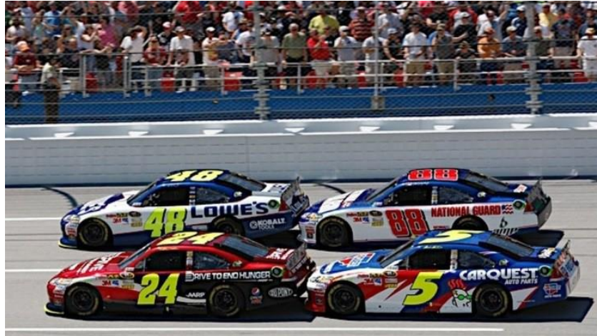
Figura 1. 28 Efecto succión en vehículos de NASCAR
