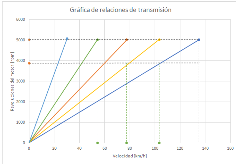
Figura 2. 23 Gráfica de relaciones de transmisión posibles para todas las velocidades con segunda y tercera modificada
