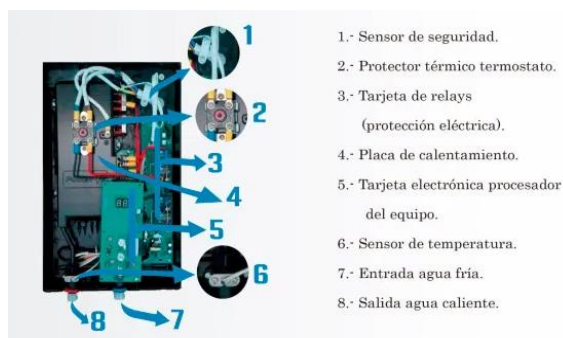
Partes internas del calefón Heizen. Fuente: (Heizen, 2021)
