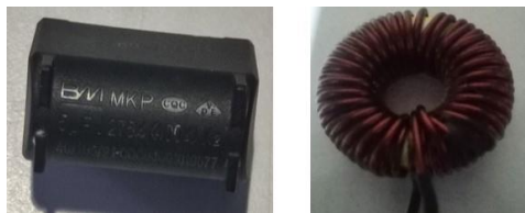
Figura 3.8. Bobina y capacitor del filtro LC
