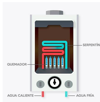
Figura 2.2. Calentador de agua instantáneo.
