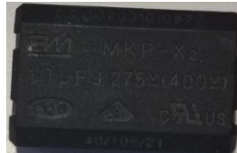
Capacitor MKP-X2 de la empresa BM. Autores: Henry Llumiquinga y José Tipán
