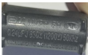
Capacitor que se emplea en el tanque resonante. Autores: Henry Llumiquinga y José Tipán
