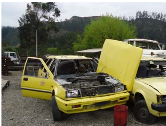
Figura. 4.7. VFU sin vidrios ni tapicería en las instalaciones de Adelca.
