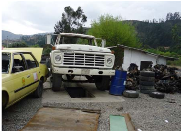
Figura 4.6. VFU en proceso de retiro de líquidos operativos en las instalaciones de Adelca.
