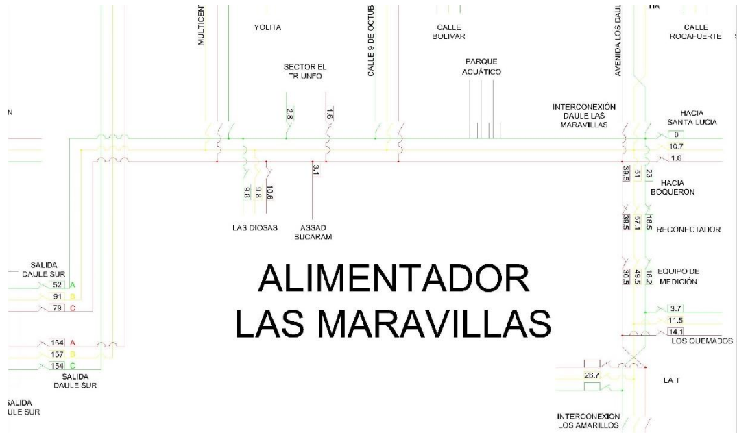
Figura 27 Lecturas de Corrientes en mínima demanda del Alimentador Las Maravillas Fuente: Autores
