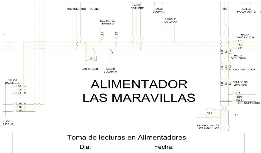
Figura 26 Lecturas de Corrientes en máxima demanda del Alimentador Las Maravillas
