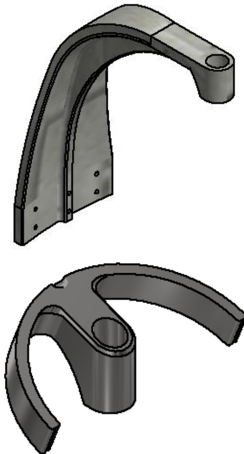
Ilustración 43. Adaptadores sensores de nivel Tanque 1 y Tanque 3
