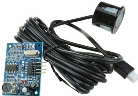
Ilustración 22. Sensor de nivel ultrasónico modelo JSN-SR04T [37]
