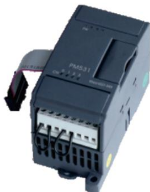
Ilustración 18. Módulo de expansión RTD, modelo K531-04RD [32].
