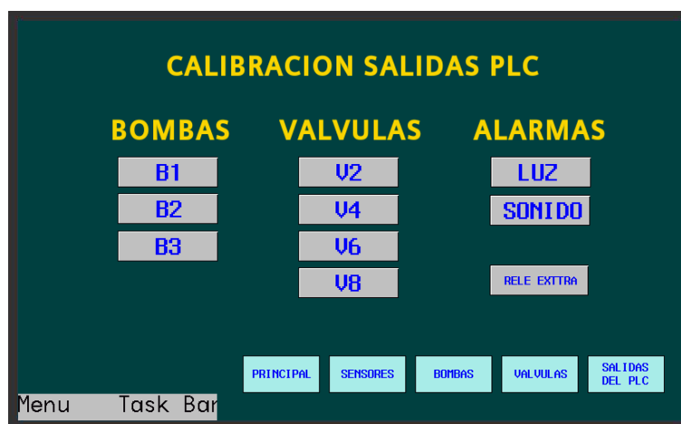
Ilustración 61. Interfaz de calibracion, control de salidas del PLC
