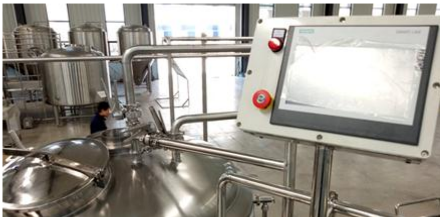
Ilustración 10. Sistemas de producción de cerveza automatizados [28].
