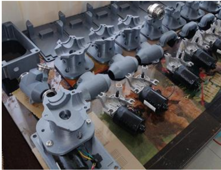
Ilustración 46. Partes para ensamblaje de las válvulas actuadas
