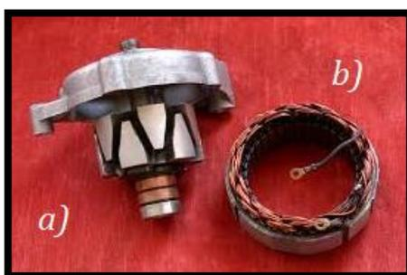
a) Rotor: corresponde a la parte móvil del generador b) Estator: corresponde a la parte fija del generador Fuente: (generadores, 2016)
