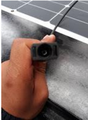
Figura B Acople de conector de paneles solares
