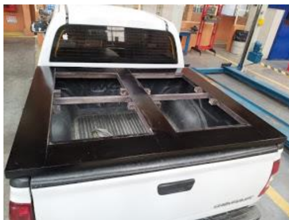
Figura H Estructura de paneles solares
