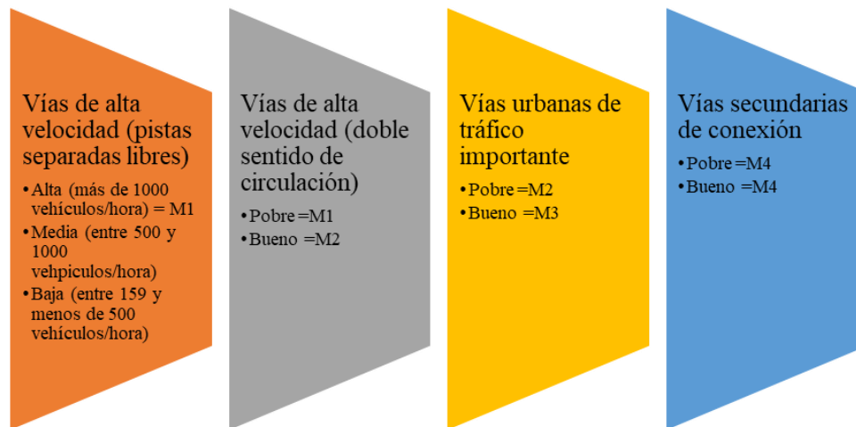
Figura 2. Tipo de alumbrado para diversas clases de vías. [2]
